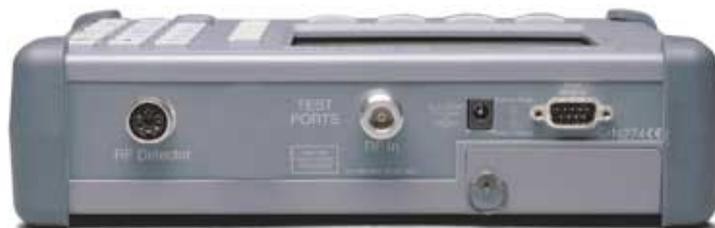
パネル接続部には、9ピンD-sub RS-232コネクタ、精密試験ポートコネクタ、DC電源入力コネクタ、ワットメータ(オプション)用RF検波器コネクタがあります。
