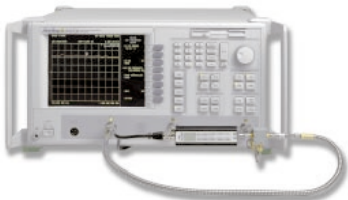
ミキサの外部雑音指数測定の一例です。2個の内部信号源を使用して、RFとLOの両方の信号をミキサに送ることができます。
