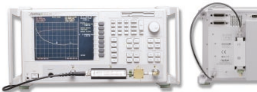
MS4622/4623シリーズを使用した雑音指数測定の外部と内部の接続
