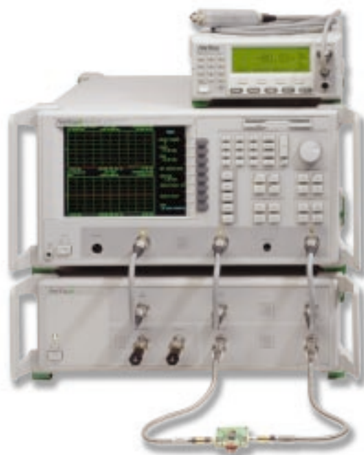
たった1回の接続で出力アンプの測定ができる テスト用セットアップの完成状態
