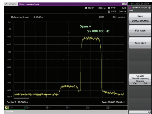
希望波 + 変調妨害波 の一例 (スペクトラム)
