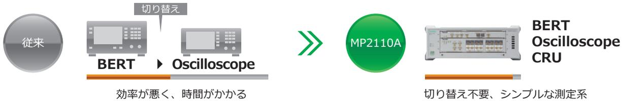
1筐体にBERTとサンプリングオシロスコープを内蔵可能であるため、測定結果を一括で取得し、かつアイパターンと同時に表示できます。そのため、マルチチャンネル光モジュール/デバイスの評価に必要なすべての測定結果を一目で評価でき、測定時間を大幅に短縮できます。
