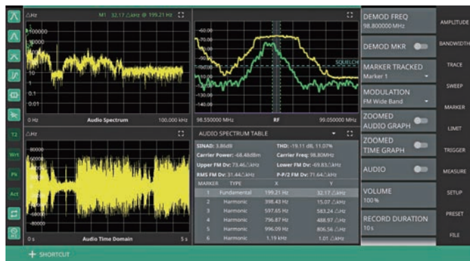
AM/FM変調解析画面：測定結果、RFスペクトラム、オーディオスペクトラムを同時表示
