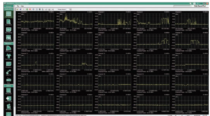
オプション0407 ビジョンハイスピードポートスキャナは複数のRFチャネルを監視 本機能は1組のMS2070A、PCのみで実施可能
