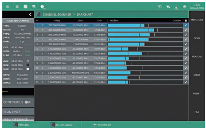
GSM、LTE、5Gバンドをモニタ(棒グラフチャート)
