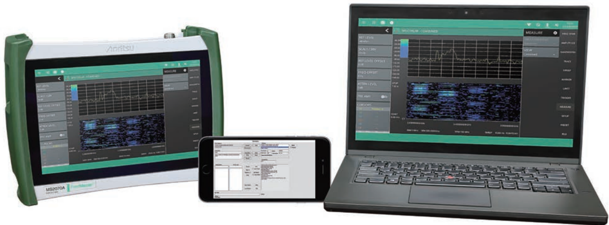
MS2070Aをリモート制御：MS2070A PCリモートユーザインタフェース（無償ダウンロードPCソフトウェア） またはユーザ作成のアンドロイドスマートフォンのアプリ
