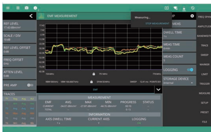
EMFの結果表示：各アンテナ軸からの電力 および定義時間でのピーク電力と平均電力のサマリ
