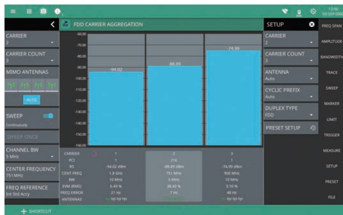
キャリアアグリゲーションモードでのOTA測定 複数のLTE信号の捕捉
