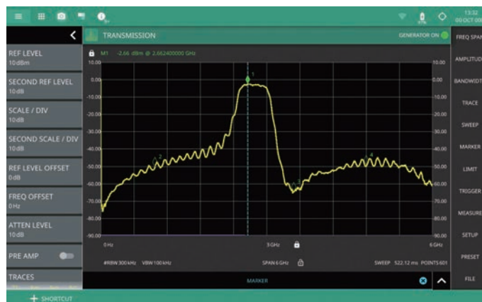
トラッキングジェネレータによるバンドパスフィルタの測定
