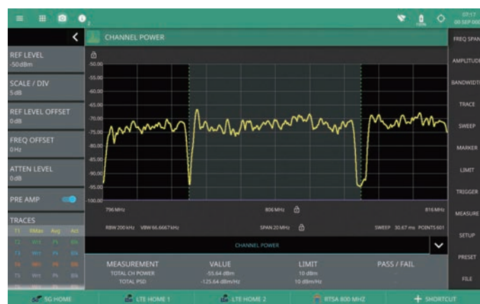
隣接キャリアに挟まれたチャンネルパワーの測定
