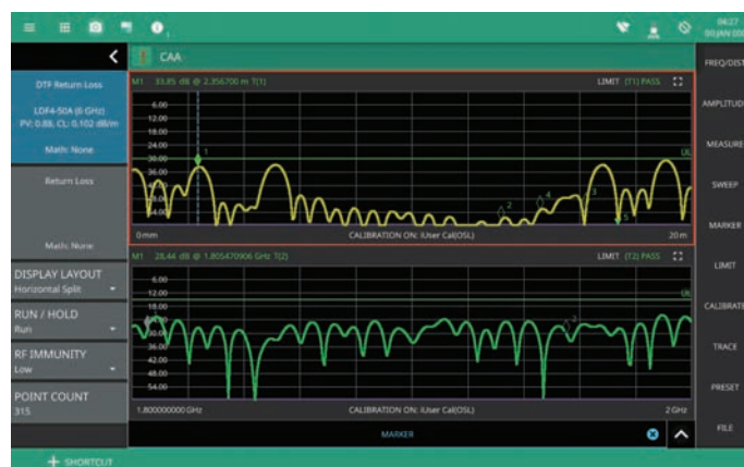
デュアルディスプレイの例： 20 mケーブルのリターンロスおよびDTFを表示
