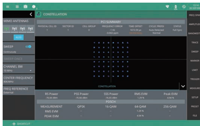
LTE変調品質(PBCHおよびPDSCHにおけるEVM測定)
