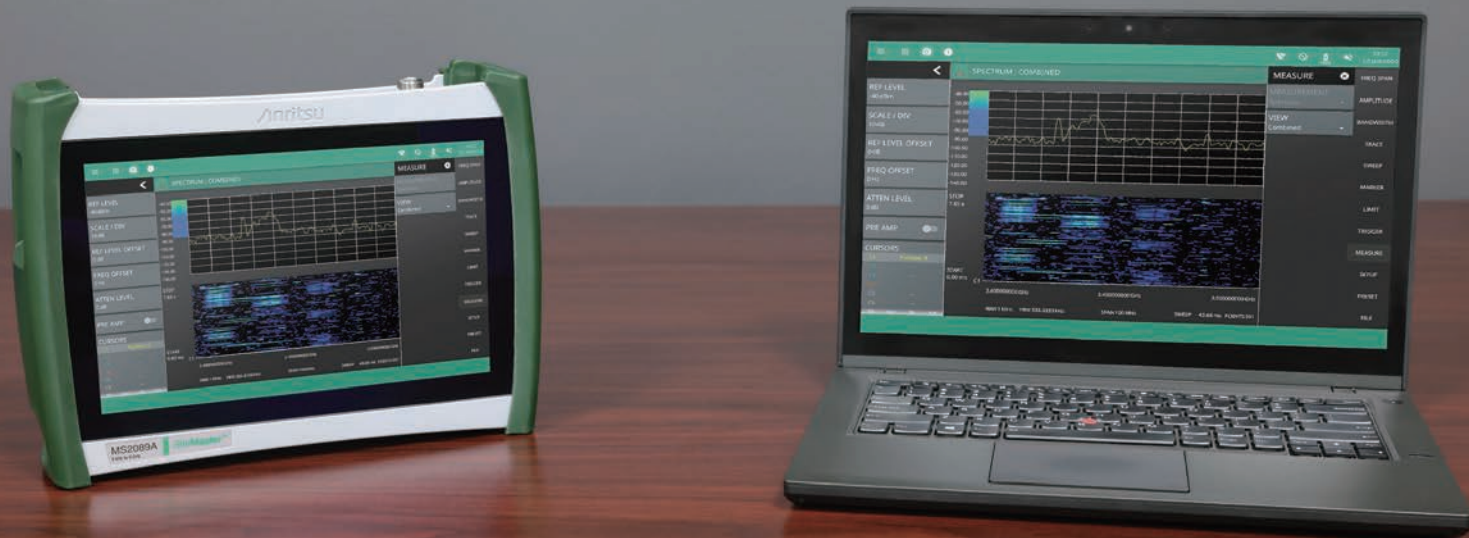
リモートGUIアプリケーション(PCとMS2085A/89AをWi-Fi接続)
