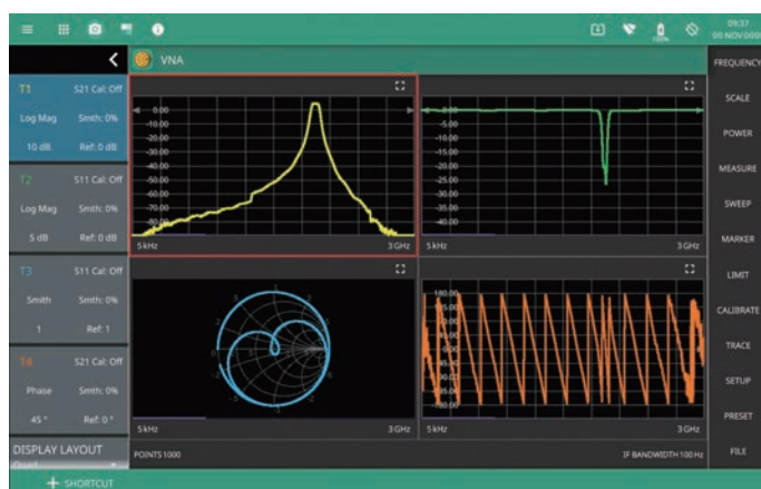
4画面表示：バンドパスフィルタなどコンポーネントの特性解析に有効
