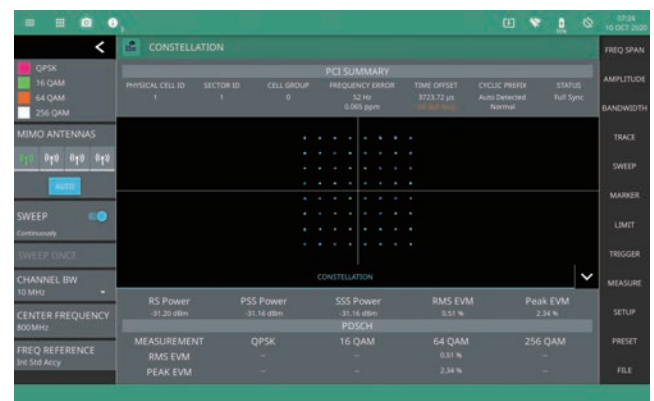
コンスタレーションダイアグラム (LTE PBCH、PDSCH) : 送信変調器の歪みを強調表示
