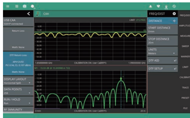
ケーブルおよびアンテナフィードの リターンロスと DTF (障害位置検出) の同時表示
