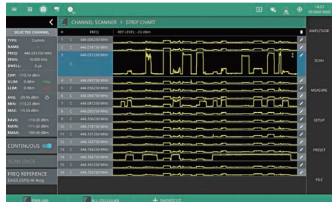
ストリップ チャート モードは、全チャンネルの信号レベルを経時的にモニタ
