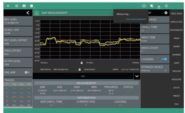
EMF の結果表示 : 各アンテナ軸からの電力および 定義時間でのピーク電力と平均電力のサマリ
