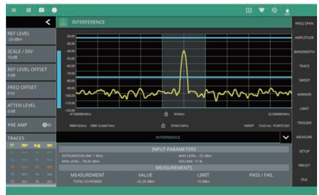
オーディオトーン機能: 信号レベルの強弱に合わせて音のピッチ、音量が変化 (オプション0024)
