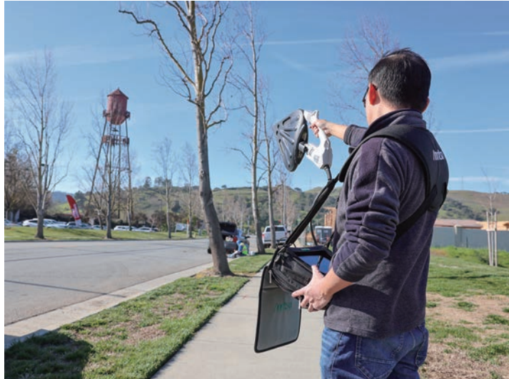
インターフェアレンスハンター MA2700Aと指向性アンテナを使い、 RF信号の迅速な位置推定が可能
