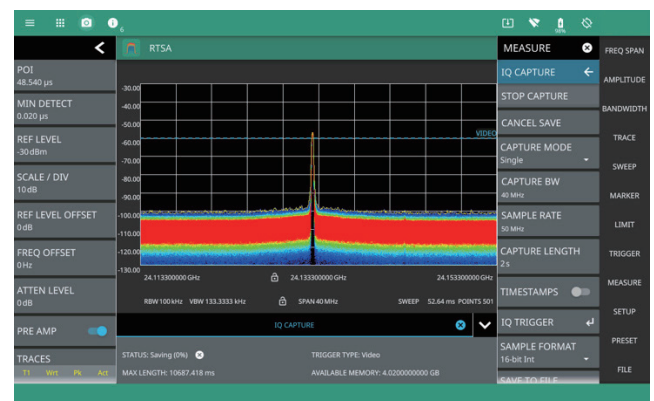
トリガ (Free Run、External、Video (Level)) は RTSA の IQ データキャプチャでも使用可能
