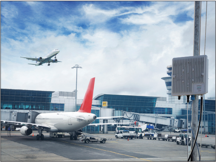
空港に設置されたアンリツのリモートスペクトラムモニタ
