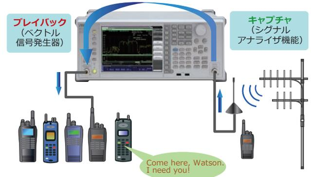
実際のRF環境を使用した繰り返し実施できる無線機(デバイス)の性能試験
