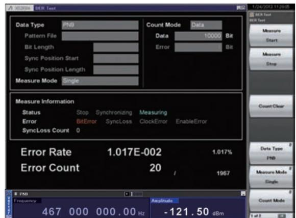
BER測定機能 (上側) とベクトル信号発生器 (下側) の測定例
