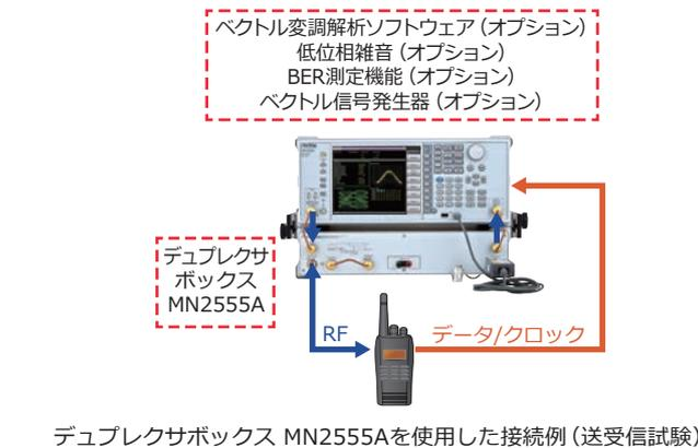
デュプレクサボックス MN2555Aを使用した接続例 (送受信試験)
