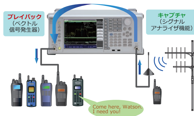
実際のRF環境を使用した繰り返し実施できる無線機（デバイス）の性能試験
