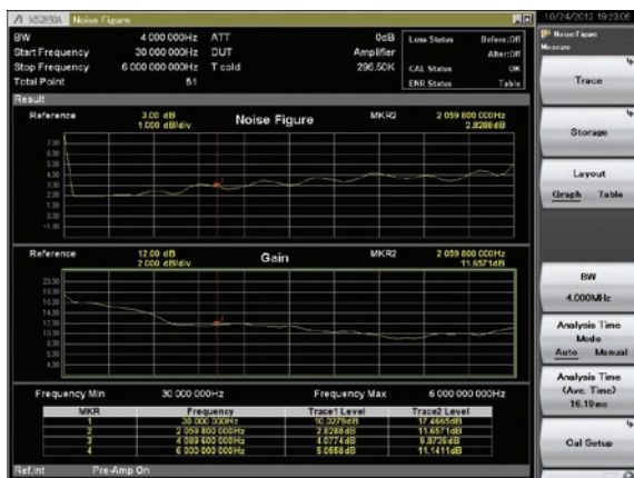
結果表示：グラフ表示の例 (周波数モード：Sweep、画面レイアウト：Graph)
