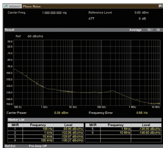
位相雑音測定 低位相雑音 MS2840A-066 : Off 測定周波数 : 1 GHz、プリアンプ : Off
