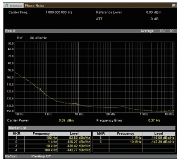
位相雑音測定 低位相雑音 MS2840A-066 : On 測定周波数 : 1 GHz、プリアンプ : Off
