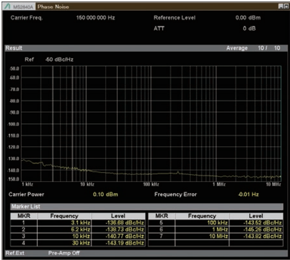
位相雑音測定 低位相雑音 MS2840A-066 : On 測定周波数 : 150 MHz、プリアンプ : Off
