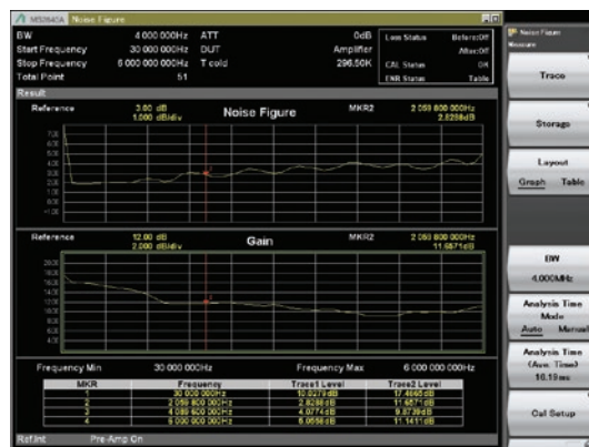
結果表示 : グラフ表示の例 (周波数モード : Sweep、画面レイアウト : Graph)
