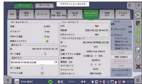
IEEE 1588 v2スレーブクロックの状態表示
