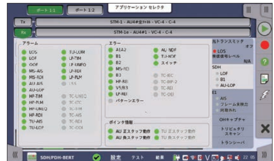
SDH/SONET回線のエラー/アラーム状態表示
