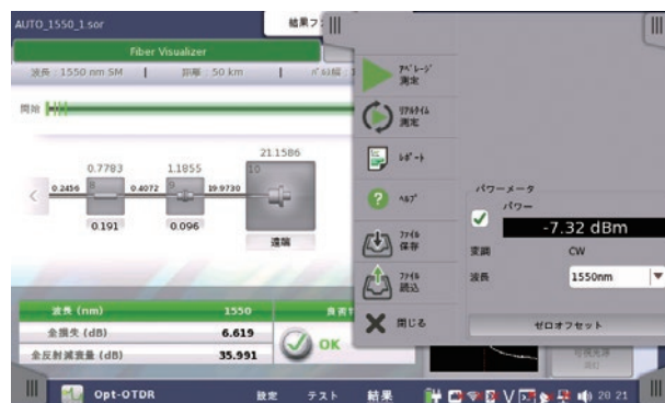
OTDRと光パワーメータの同時使用
