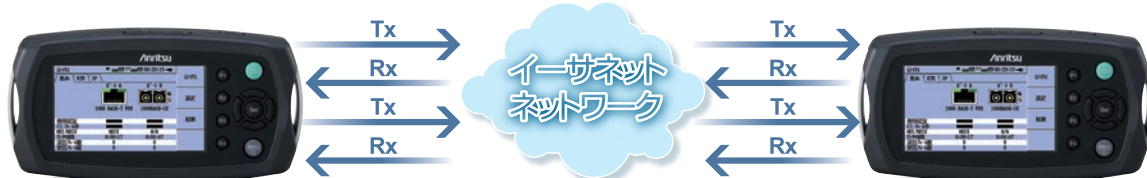
エンドツーエンド試験で双方向のパフォーマンスを個別、または同時に試験 2ポート同時試験で多ポート試験を効率化
