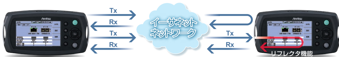
ループバックまたはリフレクタ機能を使ったシングルエンド試験 2ポート同時試験で多ポート試験を効率化
