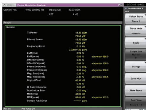
変調方式：O-QPSKの例
