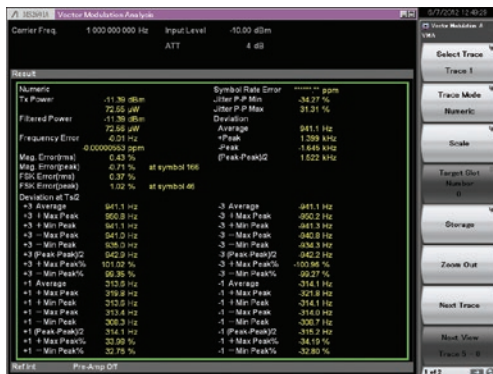
変調方式：4FSKの例
