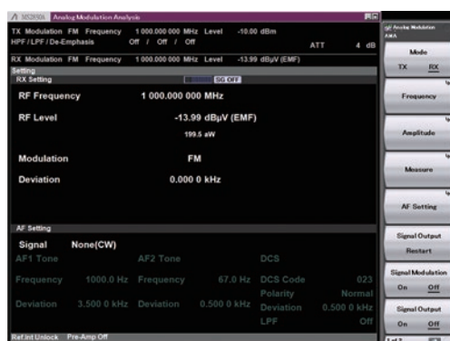
RF信号の出力画面例 (アナログ信号発生器 オプションのみ搭載)
