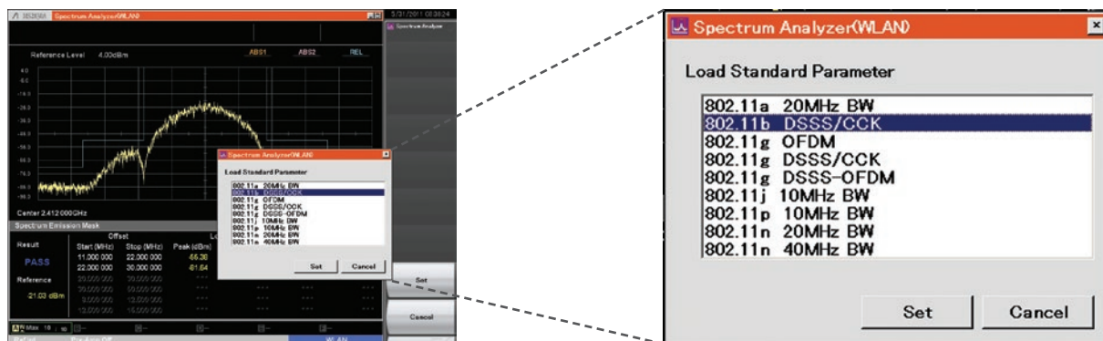
例) スプリアスエミッションマスク (SEM) 測定テンプレート
