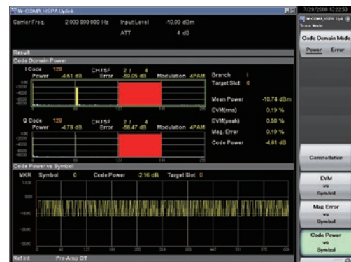
コードドメインパワーおよびコードパワー vs. シンボル
