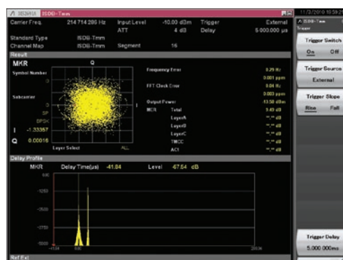
測定例：遅延プロファイル画面
