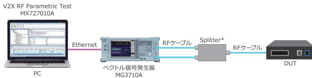
図4: 受信測定時の試験系(例)
