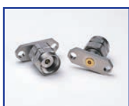
V103M-012 0.30mm ガラスピーズピン 用 V オス フランジラー チャ、2 穴、 DC ~ 65GHz
