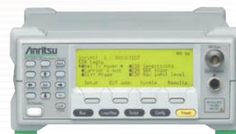
MT8852Bは、最新のBluetoothコア仕様のRF送受信特性を評価します。フルループバックに対応、高速測定ができます。
