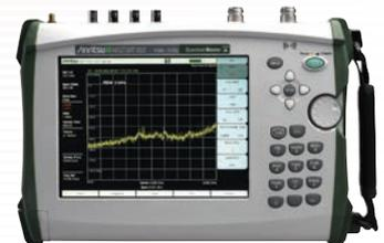
MS2720Tは、9 kHz~43 GHzまでの周波数範囲をカバーし、モバイル基地局の登録点検やマイクロ波回線保守など、さまざまなフィールド測定を必要とする環境や用途においても高確度な性能を提供します。
