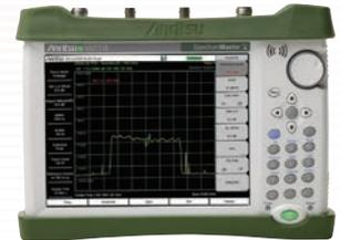
MS2711E/12E/13Eは、フィールド測定において、さまざまな測定が可能なハンドヘルドタイプのスペクトラムアナライザです。スペクトラムアナライザ機能のみでなく、電界強度測定、妨害波の調査、LTEやISDB-Tなどの各種システムの変調解析ができます。タッチパネルを採用したGUIにより、簡単に操作、および測定ができます。
