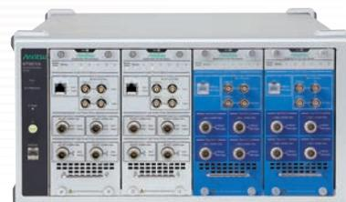
MT8870Aは、最大で4つの送受信テストモジュール MU887000A/01Aを装着でき、各テストモジュールを独立して制御できます。またMT8870Aに測定ソフトウェアを搭載することにより、各通信方式に応じた変調解析を含む送信試験をシグナルアナライザで行えます。さらに波形ファイルを搭載することにより、各通信方式の変調波形をベクトル信号発生器から出力でき、各通信規格対応デバイスの受信試験を行います。
