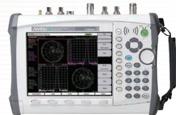
MS202xC/MS203xCは、ベクトル補正したフル2ポート測定が可能な携帯型ベクトルネットワークアナライザです。VNAは、5 kHzからカバーしており、幅広いユーザの要求に対応し、4Sパラメータを正確に測定できる低価格、高性能のVNAです。さらにMS203xCでは、スペクトラムアナライザ機能も備えており、フィールドで広範囲な測定をサポートします。
