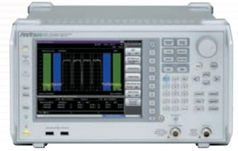
MS2690A/MS2691A/MS2692Aは、スペクトラムアナライザの基本性能である「総合レベル精度」、「ダイナミックレンジ」に磨きをかけたスペクトラムアナライザです。シグナルアナライザ機能では、広帯域信号を取り込み、FFT技術を用いて時間軸・周波数軸など多面解析ができます。
