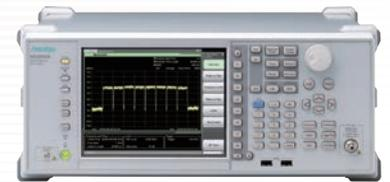
MS2850A-047/046は、最大1 GHzの解析帯域幅と優れたフラットネス性能を実現したスペクトラムアナライザ/シグナルアナライザです。この性能により5Gや衛星通信など、次世代の広帯域通信システムにおける各信号の振幅や位相をより正確に測定できます。信号解析のほか衛星通信などでは複数の周波数をモニタリングするデジタイズ用途としても活用できます。取得した大容量のデータは高速データ転送用外部インターフェースPCIe/USB3.0オプションにより従来の100倍早いスピードで外部PCへ転送できます。
