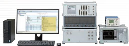
ME7800Lは、3GPP規格に準拠したLTE携帯端末/IoT端末のRF/RRM/ProtocolコンFORMANCE試験の導入に適したテストシステムです。
