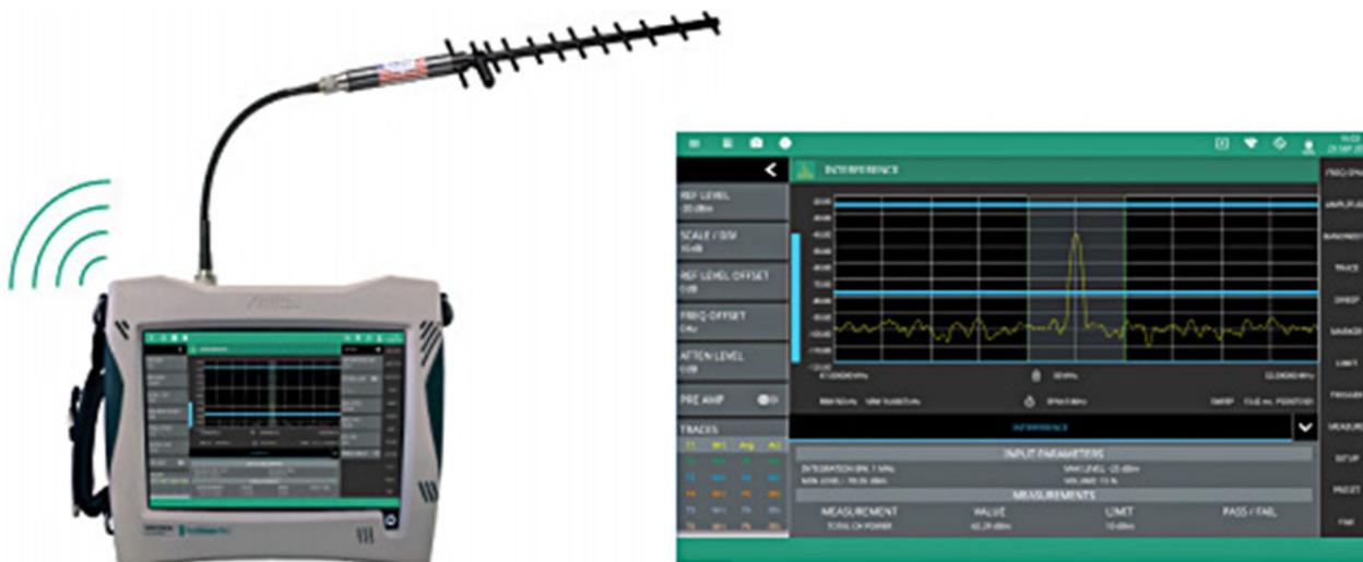
図 4 : MS2090A オーディオトーン機能による干渉波探索
