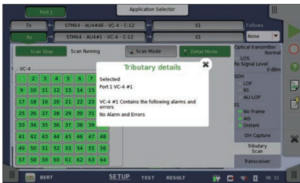
トリビュタリスキャン機能で下位のエラー、アラーム状況をすばやく確認可能
