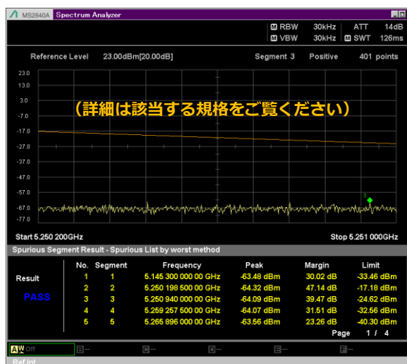
スプリアス（探索）測定例 5.2502 GHz～5.251 GHz
