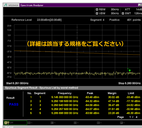
スプリアス（探索）測定例 5.251 GHz～5.260 GHz
