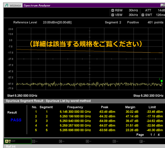
スプリアス（探索）測定例 5.250 GHz～5.2502 GHz
