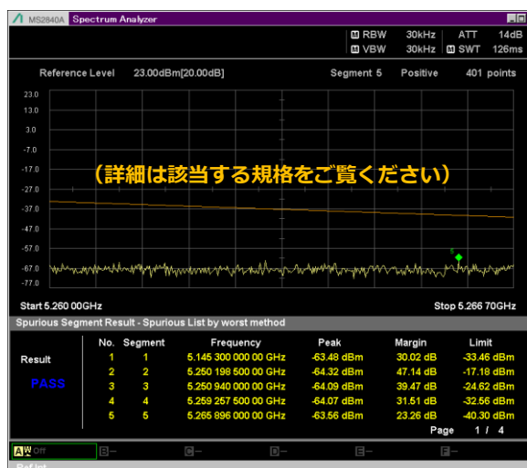
スプリアス（探索）測定例 5.260 GHz～5.2667 GHz
