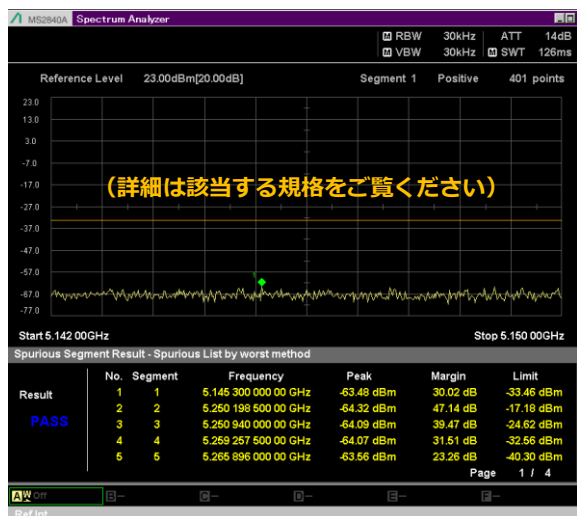
スプリアス（探索）測定例 5.142 GHz～5.150 GHz
