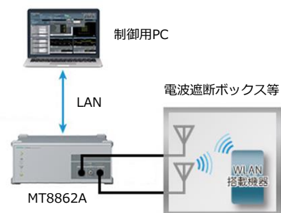
無線LAN搭載機器の無線性能評価の セットアップイメージ図
