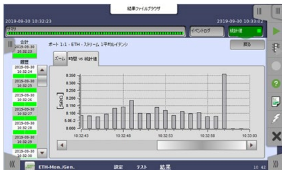
遅延時間の変動量のグラフ例 (MT1000A)
