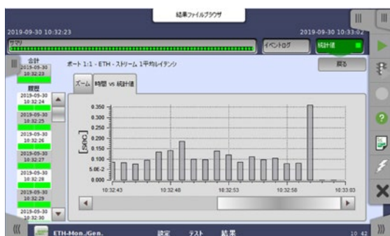
遅延時間の変動量のグラフ例 (MT1000A)
