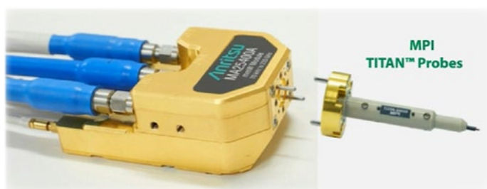
220 GHzミリ波モジュール MA25400AとMPI社プローブチップ
