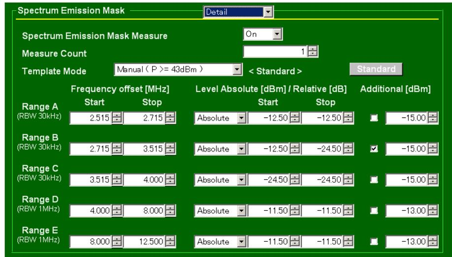
図3.4.5-1 Spectrum Emission Mask 測定パラメータ
