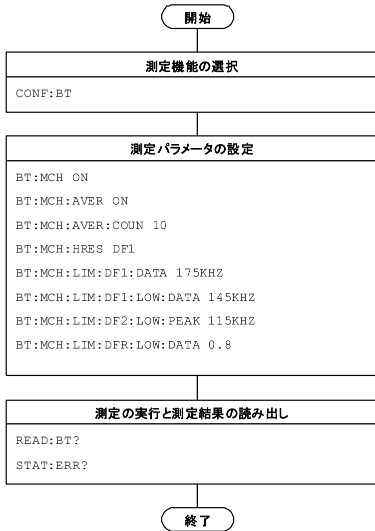
図1.2.4-1 Modulation Characteristics 測定の流れとコマンド例
