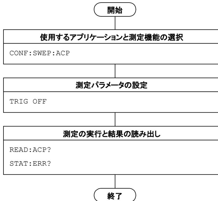
図 1.2.5-1 スペクトラムアナライザを使用した ACP 測定の流れとコマンド例
