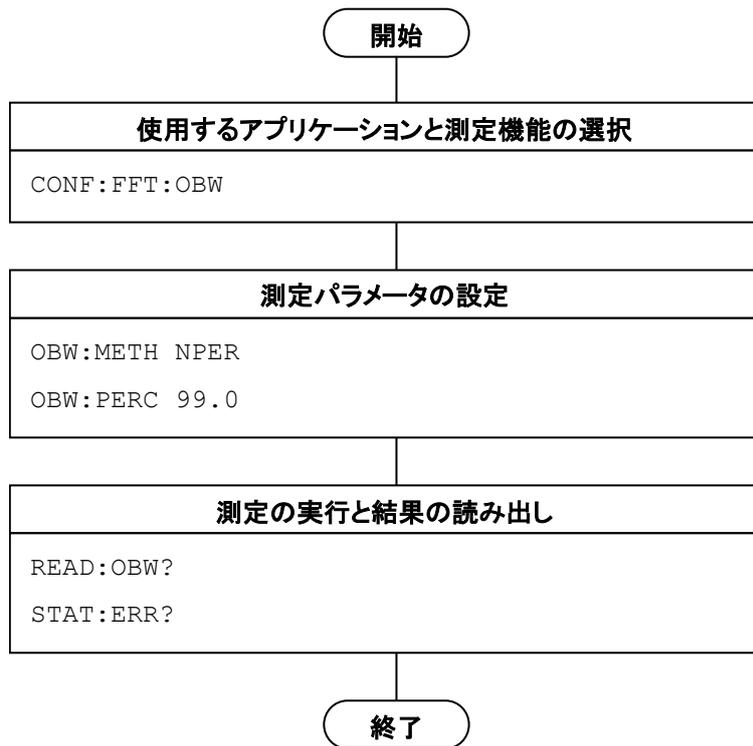
図 1.2.6-1 シグナルアナライザを使用した OBW 測定の流れとコマンド例
