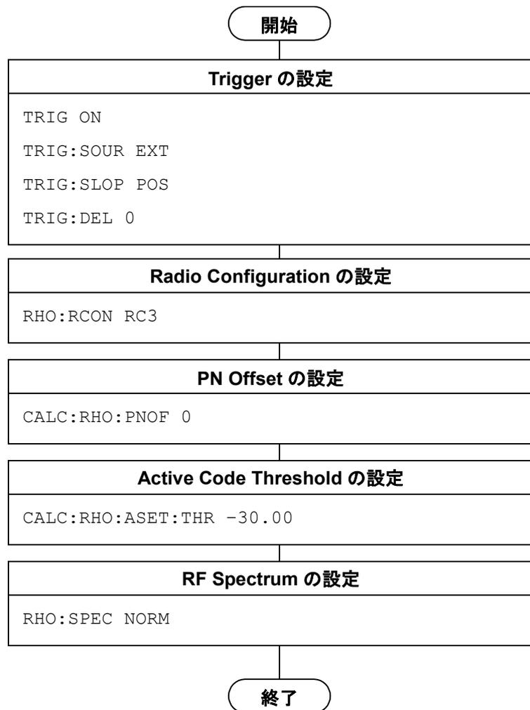
図 1.2.3-1 Code Domain 共通の設定の流れとコマンド例
