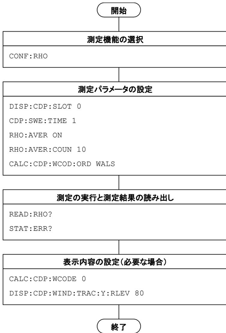
図 1.2.4-1 Code Domain 測定の流れとコマンド例
