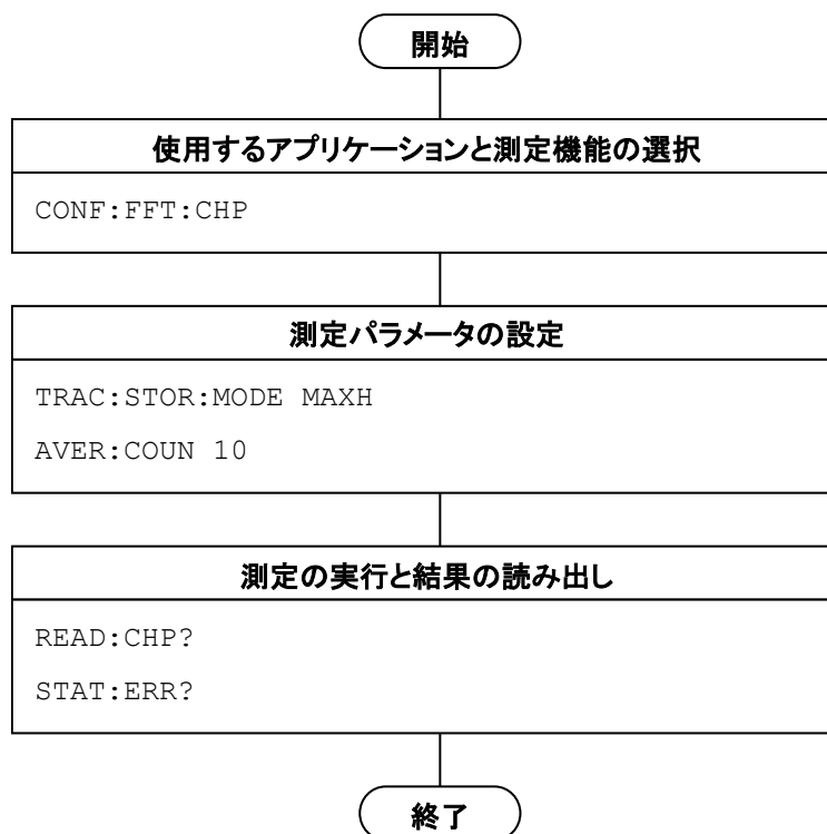
図 1.2.8-1 シグナルアナライザを使用した Channel Power 測定の流れとコマンド例
