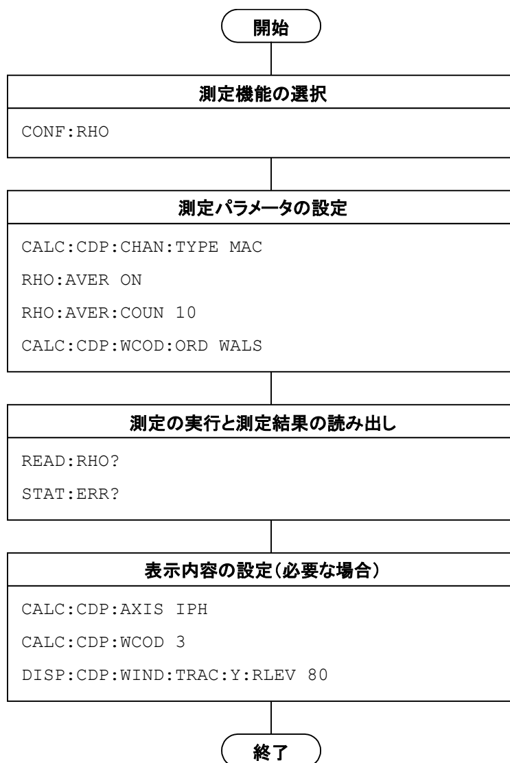
図 1.2.4-1 Code Domain 測定の流れとコマンド例
