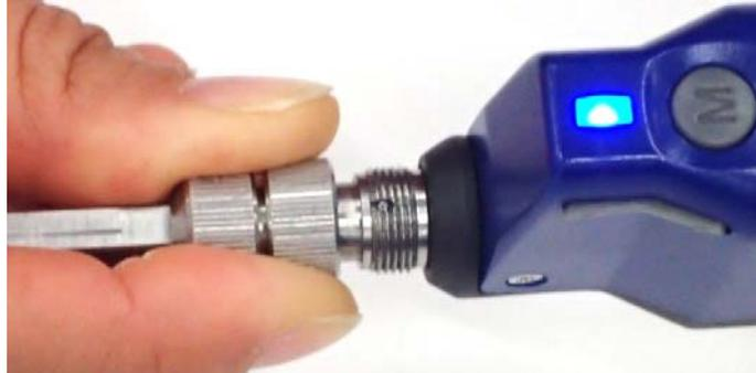
3. ピンがスリットから外れないようにアダプタを押しながら、リングを反時計回りに回して固定します。
