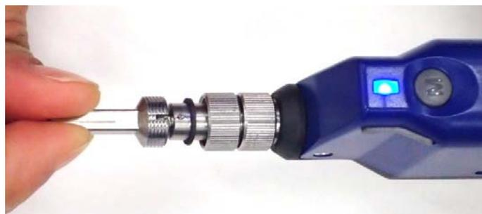
4. リングを反時計回りに回して固定します。
