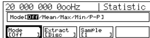
図 4.3.11-2 統計処理モードの選択
