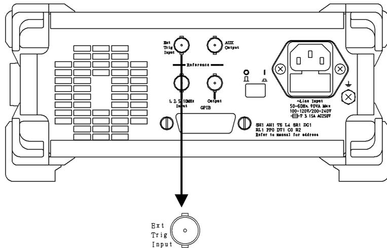
図 2.2.5-1 External Trigger Input コネクタ
