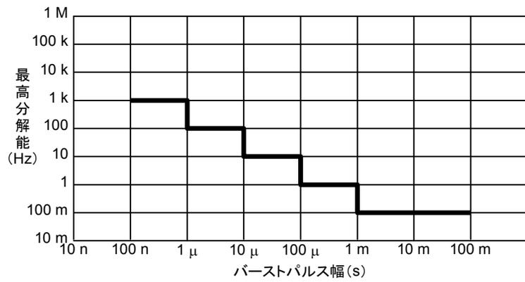
図 4.3.3-2 パルス幅 対 最高分解能
