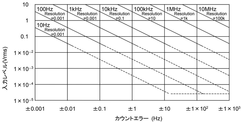
図 6.4-3 Input2 周波数測定でのカウンタエラー対入力レベル
