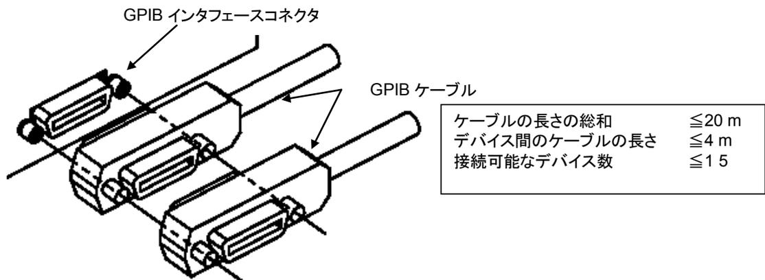
図 5.5.1-1 GPIB ケーブルの接続条件
