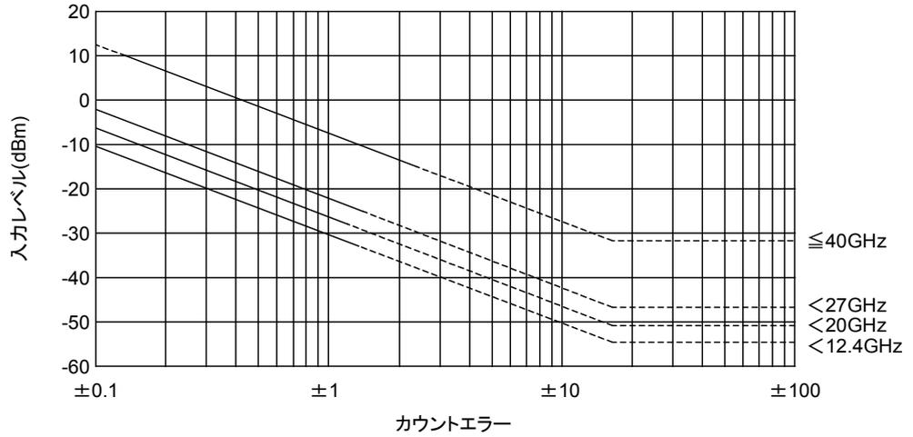
図 6.4-2 Input1 周波数測定でのカウンタエラー対入力レベル
