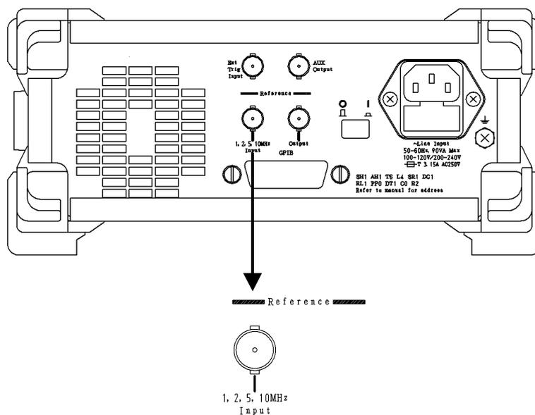
図 2.2.4-1 Reference1, 2, 5, 10 MHz Input コネクタ
