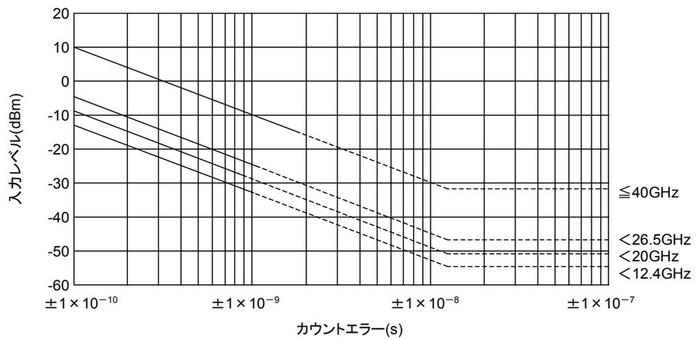
図 6.4-5 Input1 パルス幅測定 (Narrow) でのカウントエラー対入力レベル
