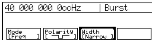
図 4.4.7-4 バースト幅選択画面
