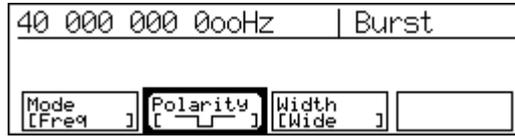
図 4.4.7-3 バースト測定の極性選択画面
