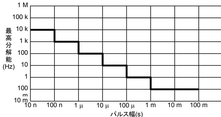
図 4.4.4-2 パルス幅 対 最高分解能
