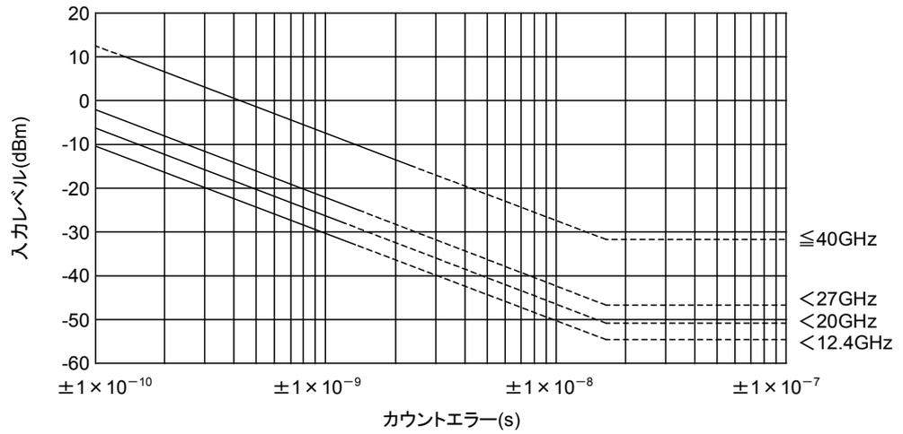
図 6.4-4 Input1 パルス幅測定 (Wide) でのカウントエラー対入力レベル
