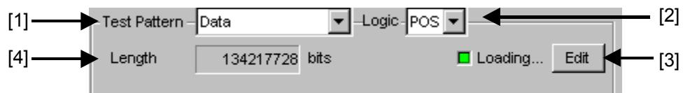
図5.3.4-1 Test Pattern (Data) 設定項目画面
