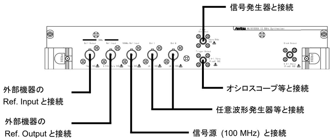
図3.2-4 外部機器との接続 (MU181000A-x01 実装時)
