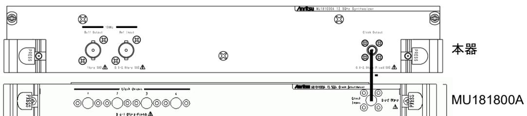
図3.2-2 MU181800A 12.5GHz クロック分配器との接続
