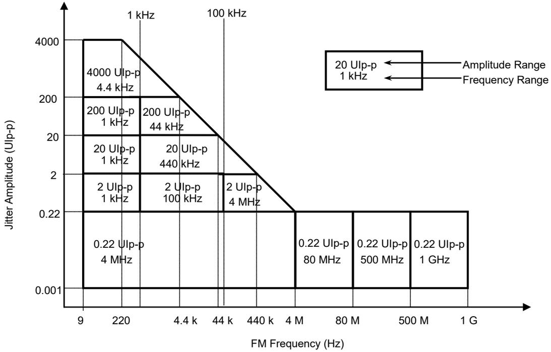
図4.2.2-5 6.4 GHz <  $F_c$  ≤ 12.5 GHz 時の Range 選択
