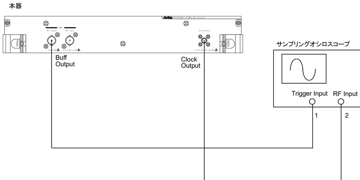
図6.3.1-1 波形測定のための接続図
