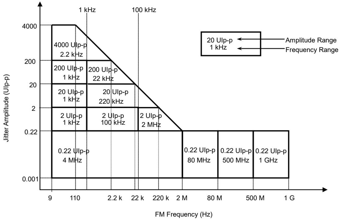
図4.2.2-6 3.2 GHz <  $F_c$  ≤ 6.4 GHz 時の Range 選択
