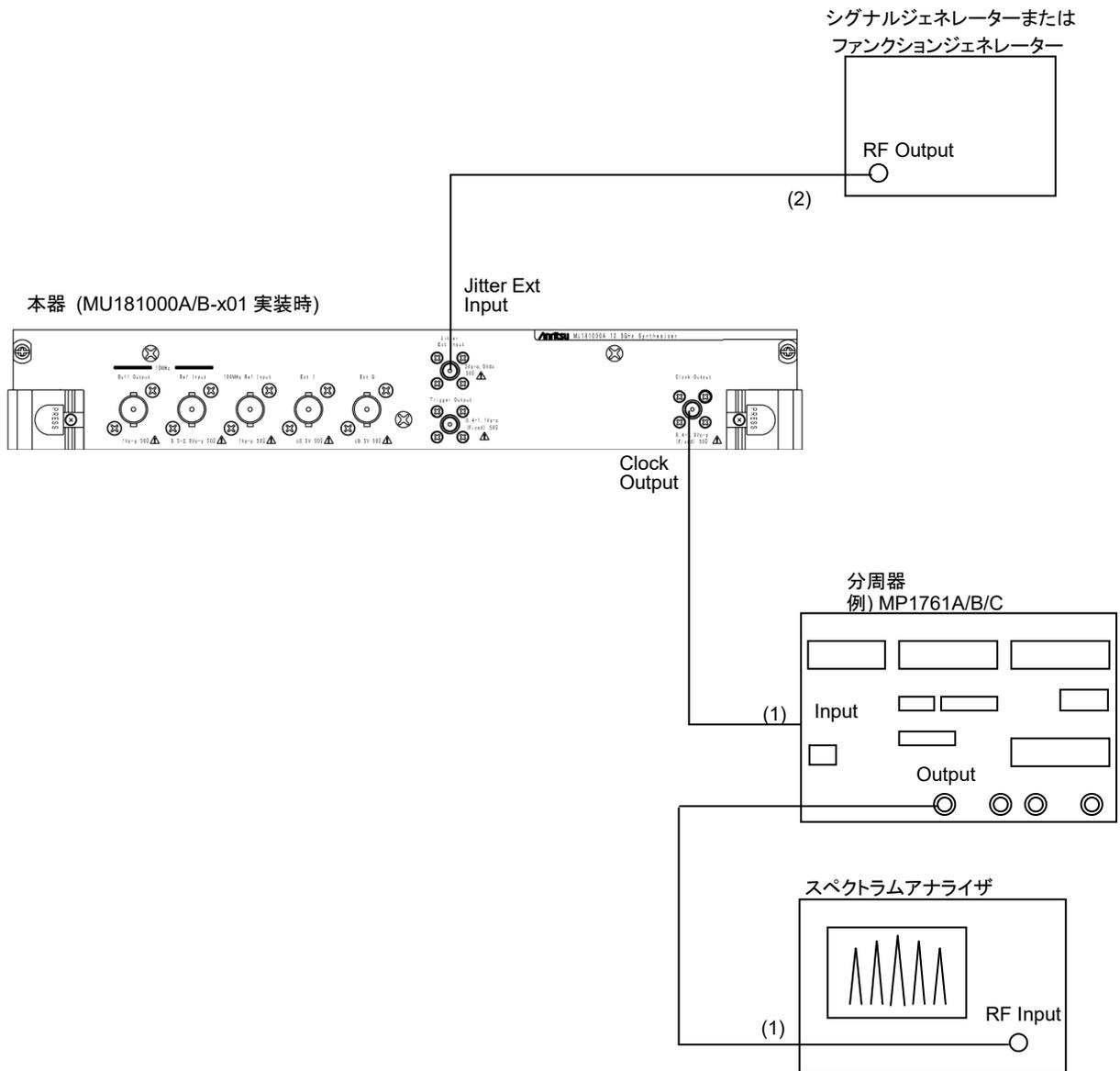
図6.3.4-2 0.4 Ulp-p 以上の正弦波ジッタ測定の接続図
