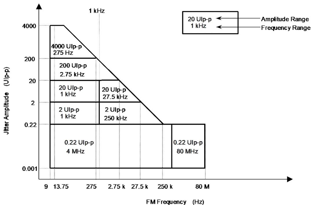
図4.2.2-9 0.1 GHz ≤ Fc ≤ 0.8 GHz 時の Range 選択
