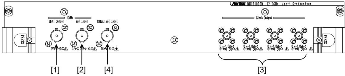
図3.1.3-1 MU181000B-x02 のパネル外観図
