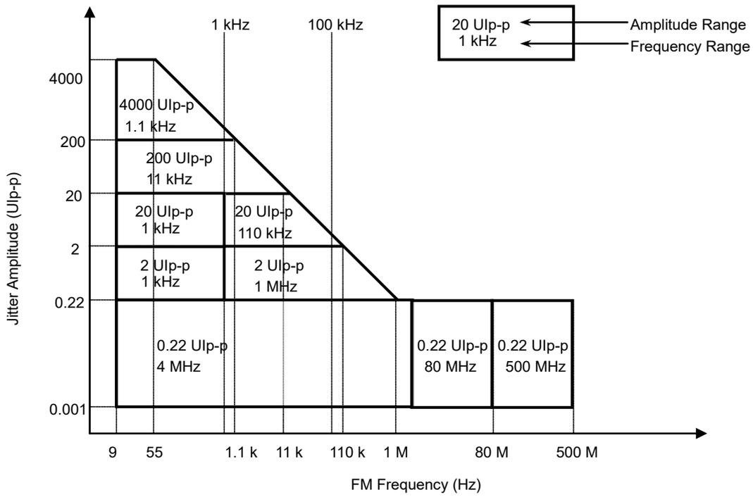
図4.2.2-7 1.6 GHz < Fc ≤ 3.2 GHz 時の Range 選択
