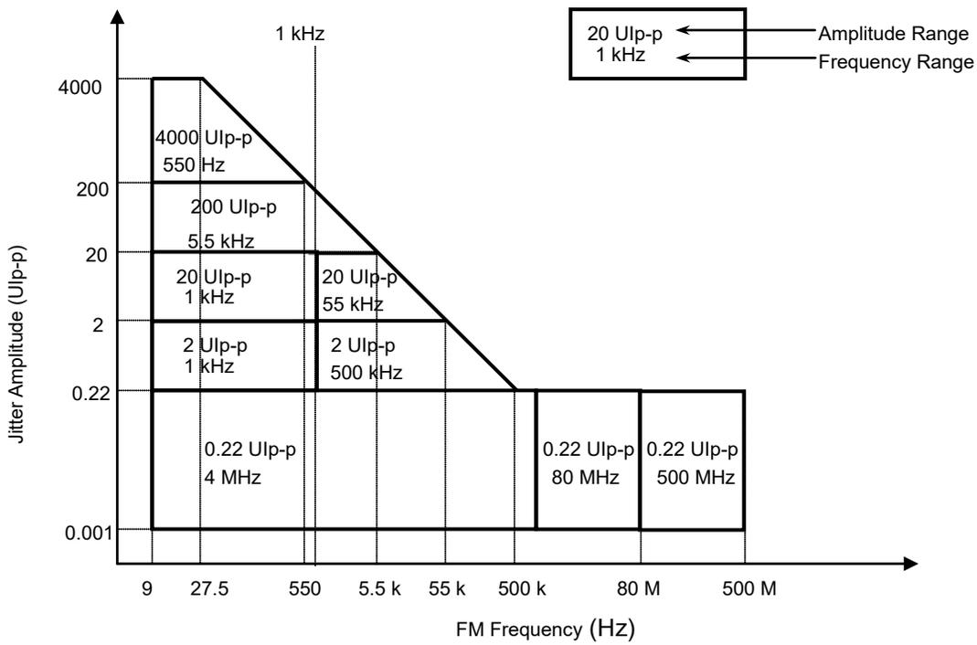
図4.2.2-8 0.8 GHz < Fc ≤ 1.6 GHz 時の Range 選択
