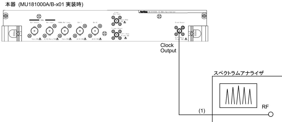
図6.3.3-1 0.4 Ulp-p 以下の正弦波ジッタ測定の接続図
