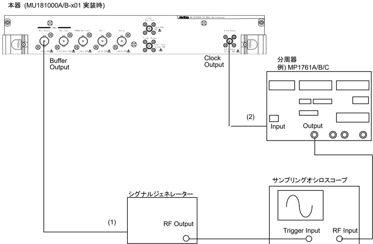
図6.3.5-1 三角波変調測定接続図
