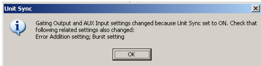
図5.9.2-2 Unit Sync ON 時の設定変更メッセージ
