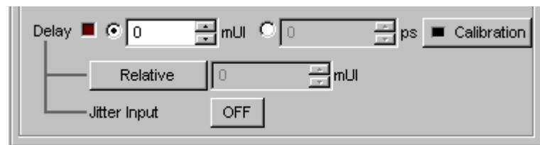
図5.1.3-1 Output タブ Delay 設定画面
