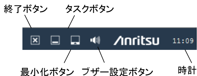
図 3.1.3-1 システムコントロールエリア
