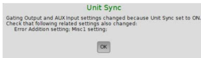
図 3.6.2-2 Unit Sync ON 時の設定変更メッセージ
