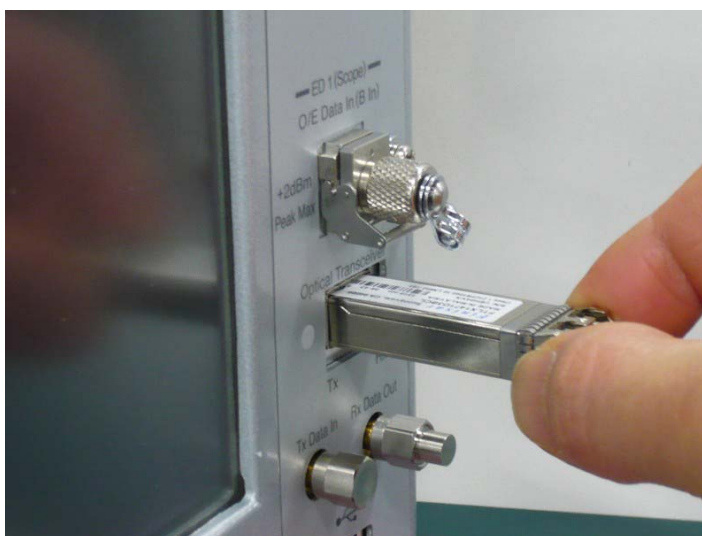
図2.8.1-1 光トランシーバの取り付け
