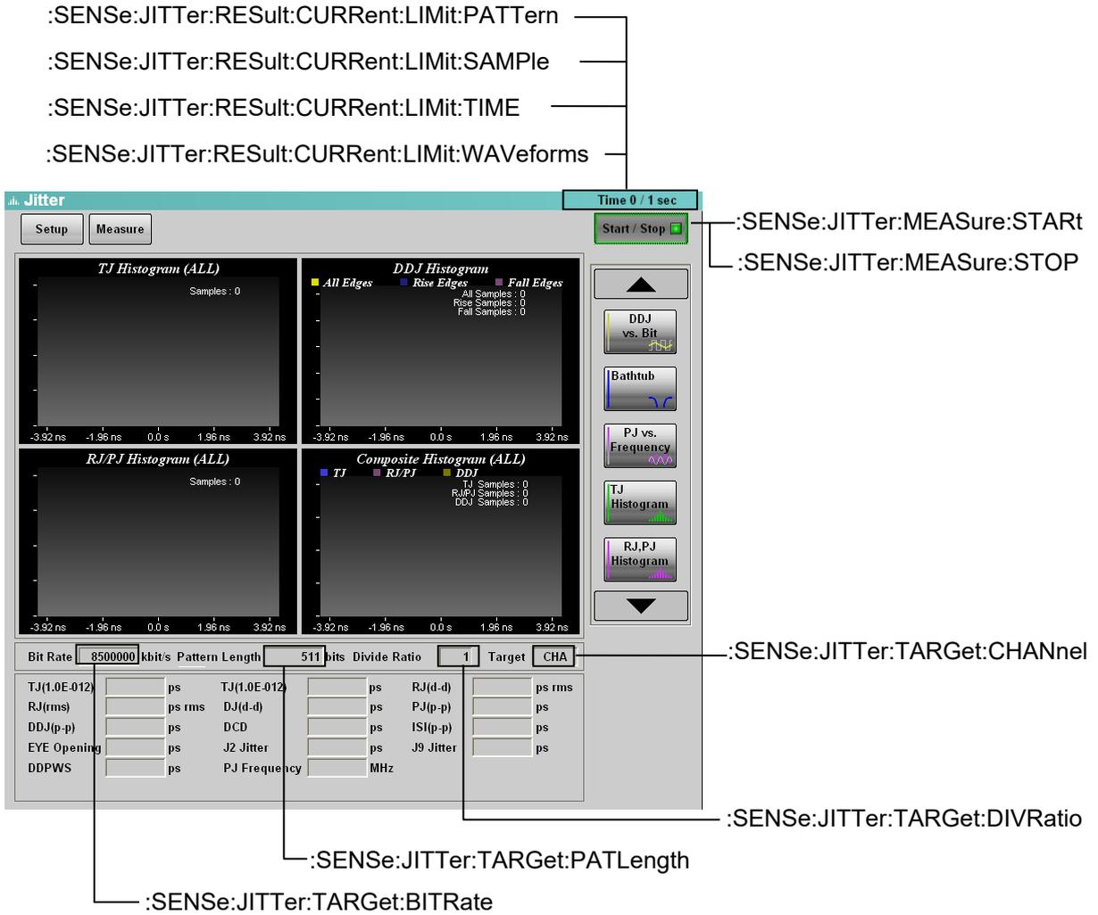
図4.3-1 Jitter パネルに対応するメッセージ 1
