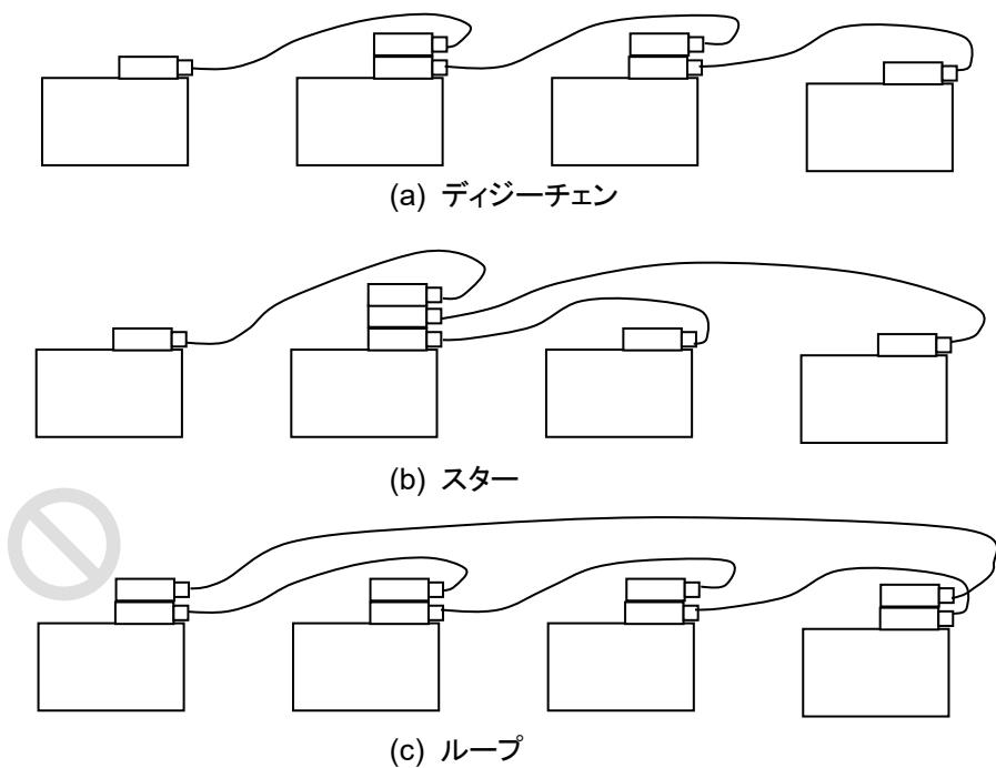
図 2.4.2-2 GPIB ケーブルの接続方法 2
