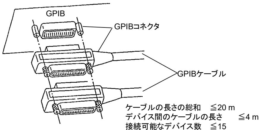
図 2.4.2-1 GPIB ケーブルの接続方法 1
