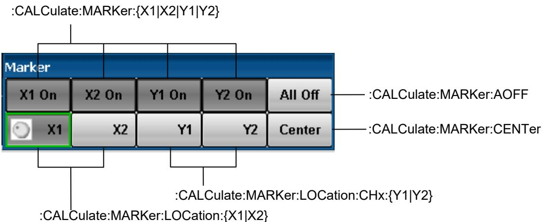
図 3.2.5.6-1 Marker ダイアログボックスに対応するメッセージ
