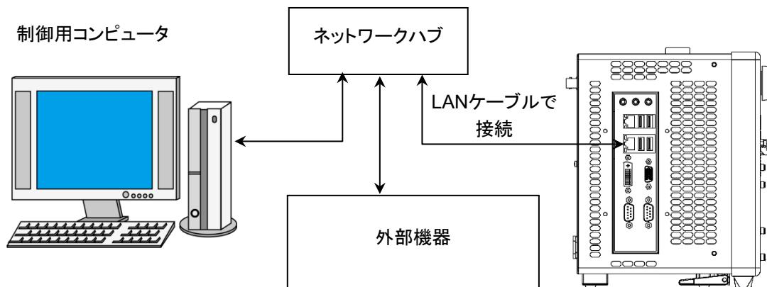
図 2.4.1-2 本器と複数の外部機器の接続例
