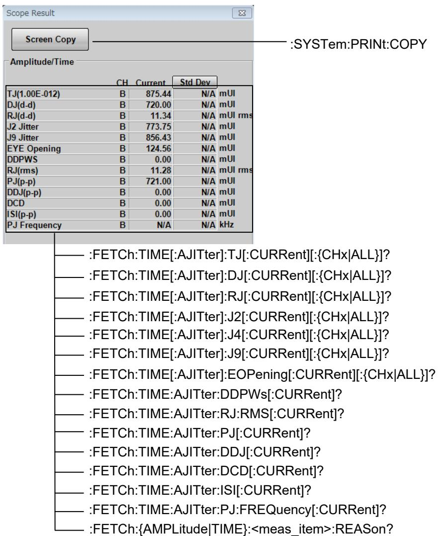
図 3.2.5.1-5 Jitter 測定結果に対応するメッセージ
