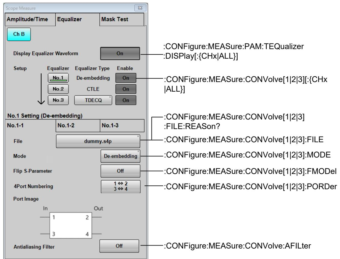
図 3.2.5.3-8 Measure ダイアログボックスに対応するメッセージ (MP2110A)
