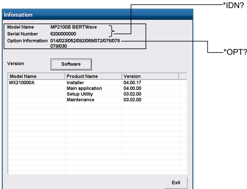
図 3.2.6-1 セットアップユーティリティの Information ダイアログボックスに対応するメッセージ
