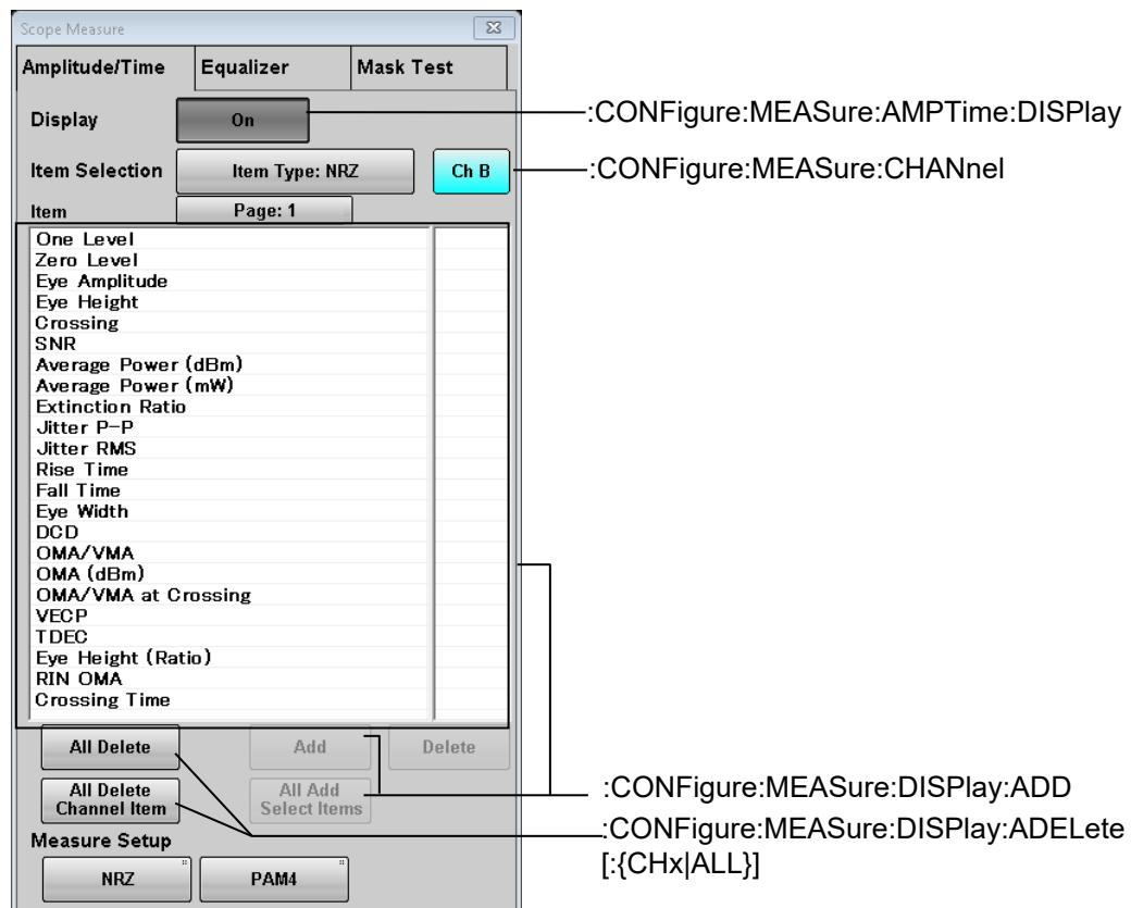
図 3.2.5.3-4 Measure ダイアログボックスに対応するメッセージ (MP2110A)
