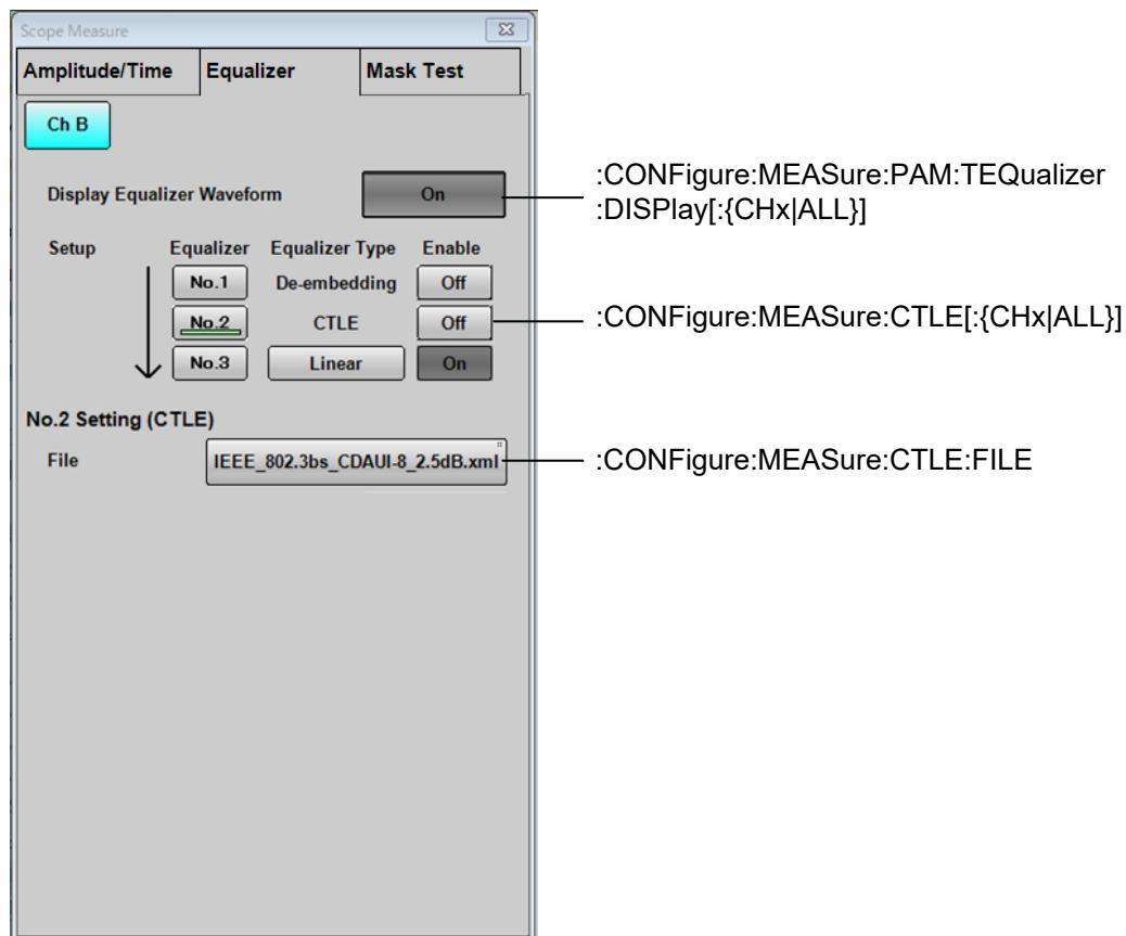
図 3.2.5.3-9 Measure ダイアログボックスに対応するメッセージ (MP2110A)
