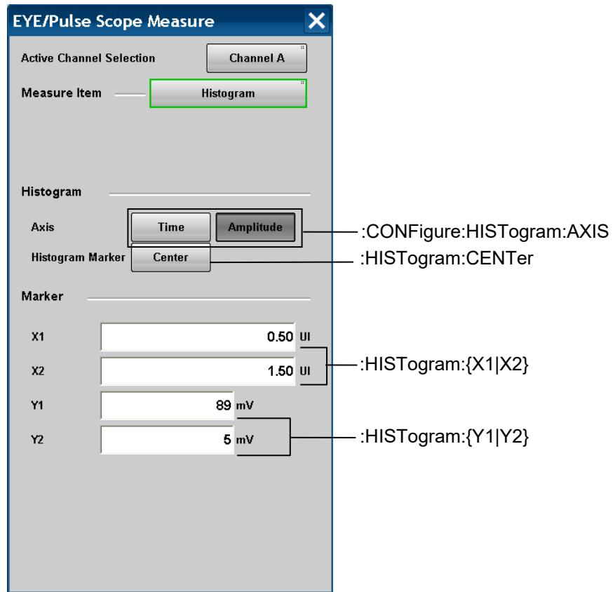
図 3.2.5.3-3 Measure ダイアログボックスに対応するメッセージ
