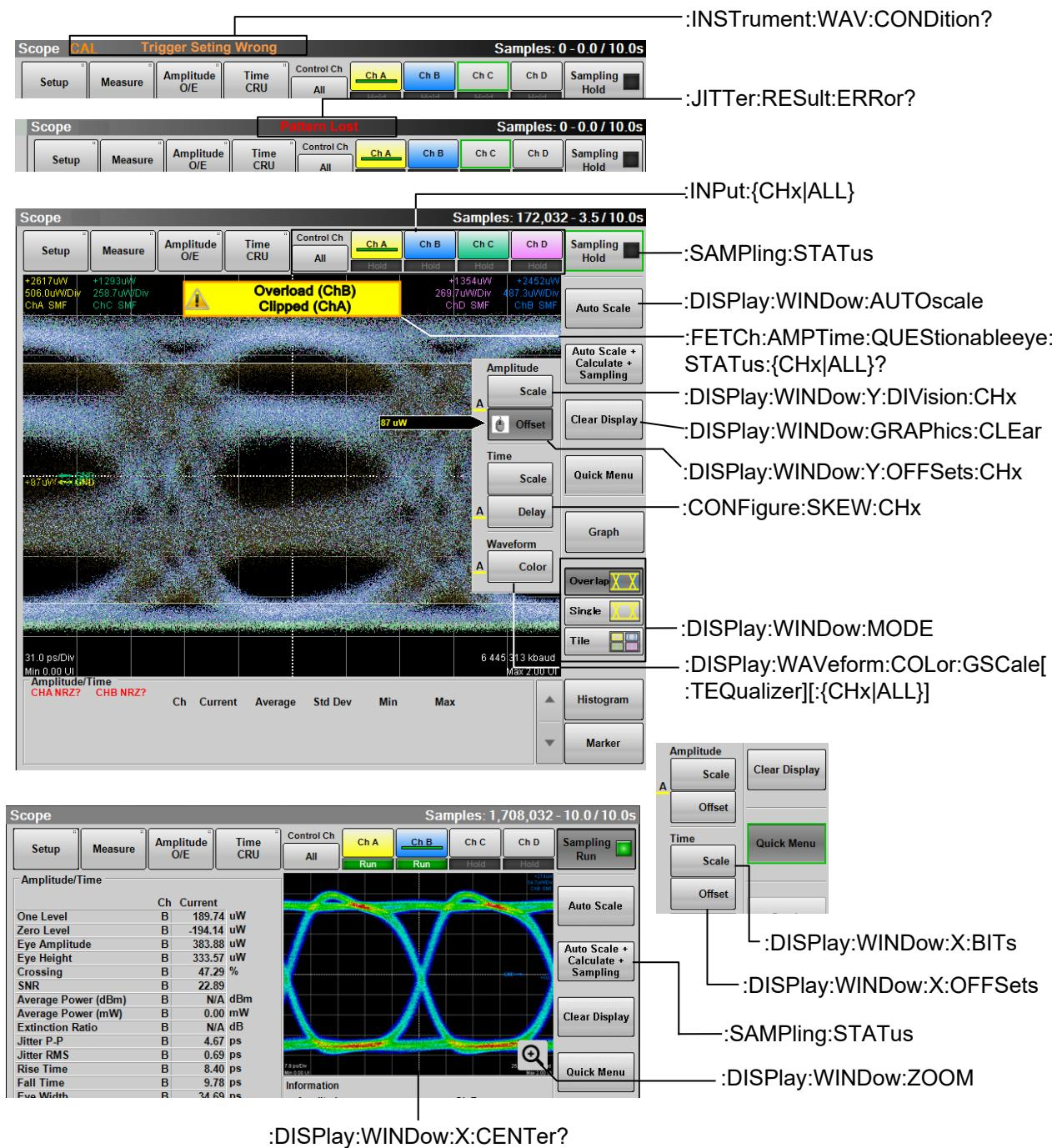
図 3.2.5.1-1 Scope パネルに対応するメッセージ (MP2110A)
