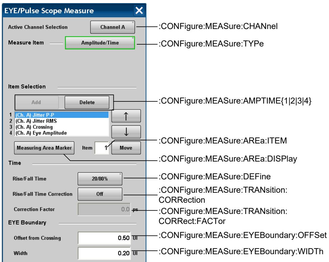
図 3.2.5.3-1 Measure ダイアログボックスに対応するメッセージ (MP210xA, MP2100B)
