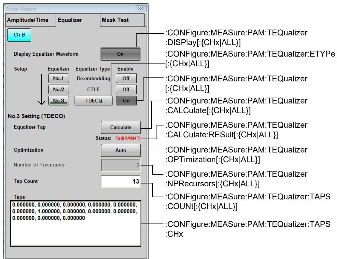
図 3.2.5.3-10 Measure ダイアログボックスに対応するメッセージ (MP2110A)
