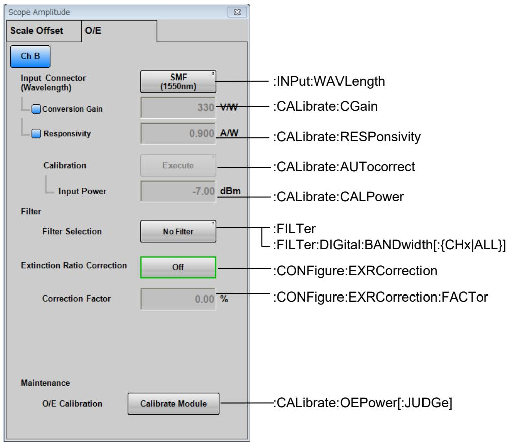
図 3.2.5.5-3 Amplitude ダイアログボックスに対応するメッセージ (MP2110A) (O/E)
