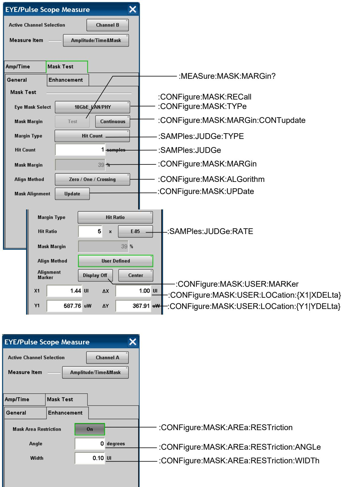
図 3.2.5.3-2 Measure ダイアログボックスに対応するメッセージ (MP210xA, MP2100B)
