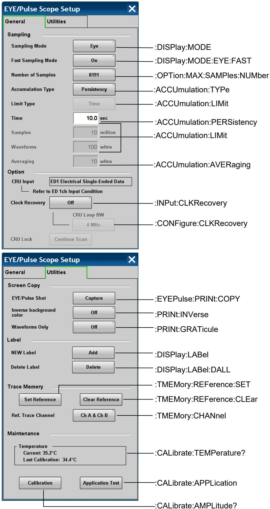
図 3.2.5.2-1 Setup ダイアログボックスに対応するメッセージ (MP210xA, MP2100B)
