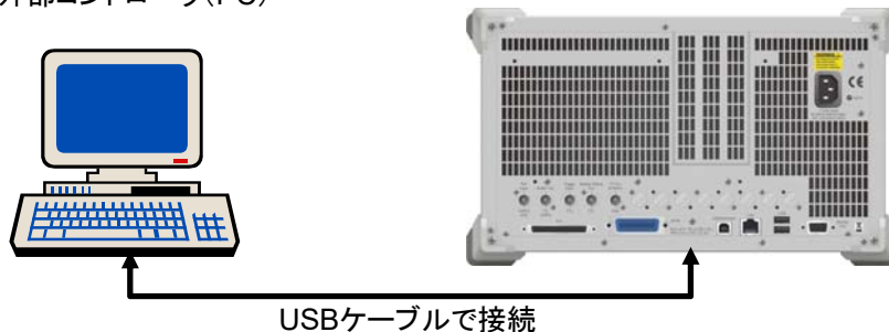
図1.2.3-1 本器と1台の外部機器の接続例
