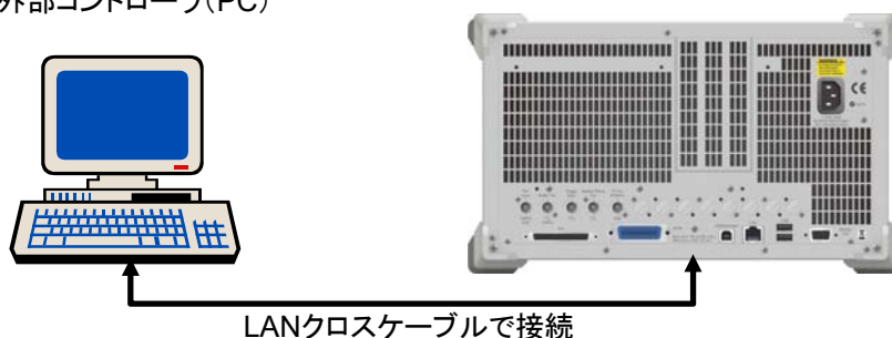
図1.2.2-1 本器と1台の外部機器の接続例
