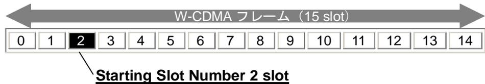
図 3.6.1-1 Starting Slot Number の設定概念
