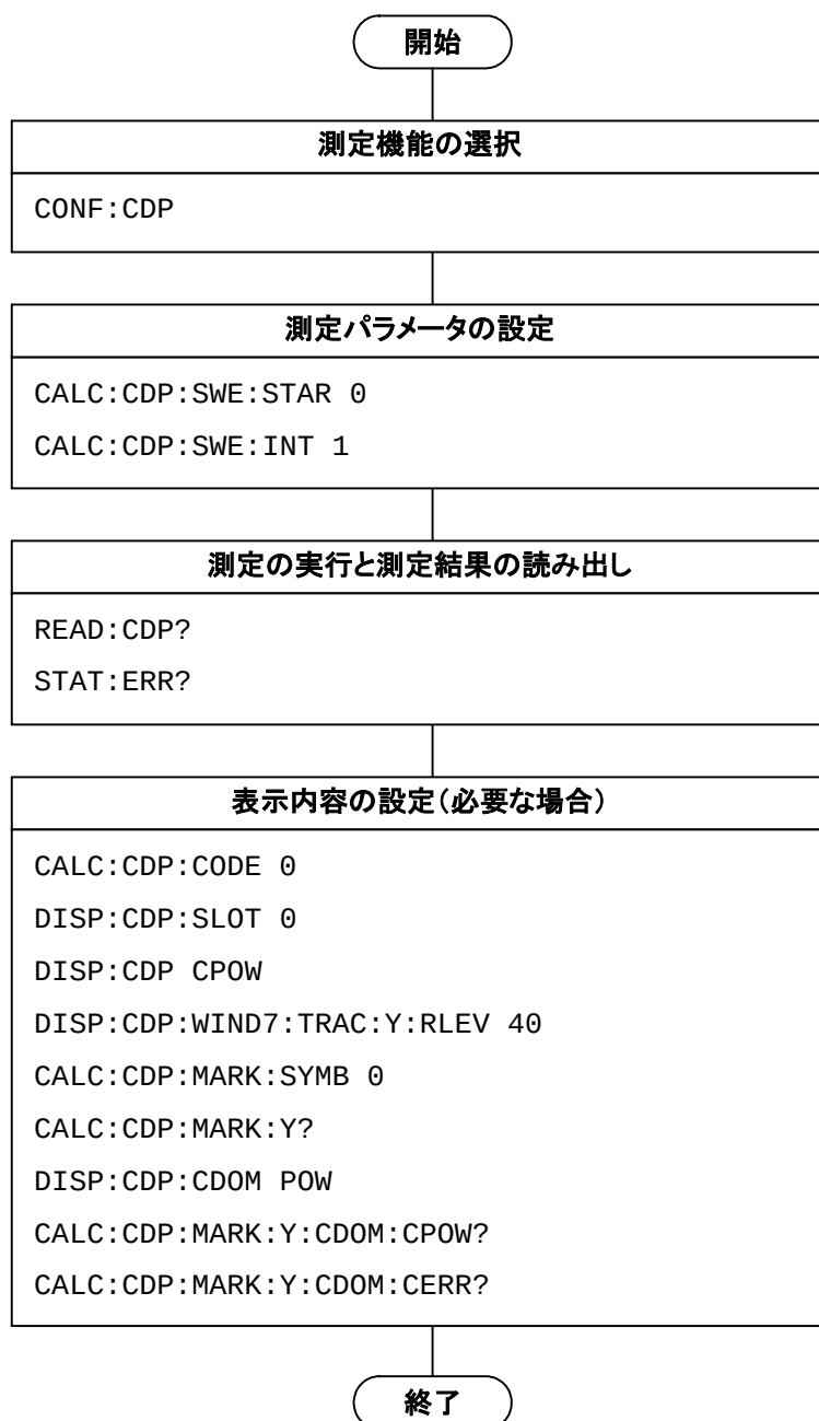
図1.2.5-1 Code Domain 測定の流れとコマンド例
