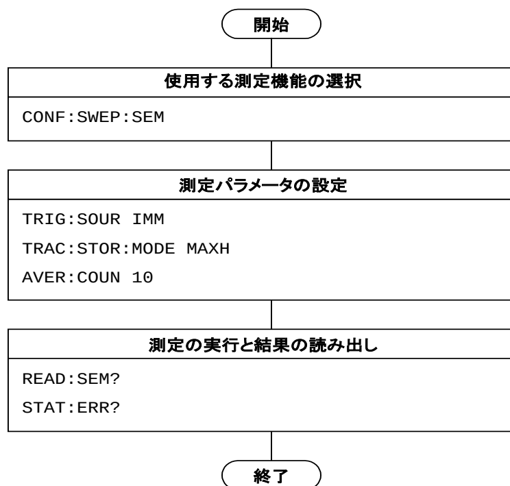
図1.2.10-1 スペクトラムアナライザを使用した SEM 測定の流れとコマンド例
