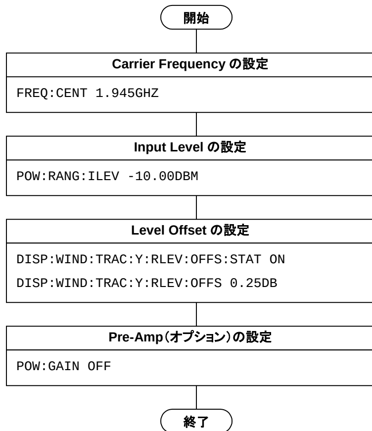
図1.2.2-1 基本パラメータの設定の流れとコマンド例
