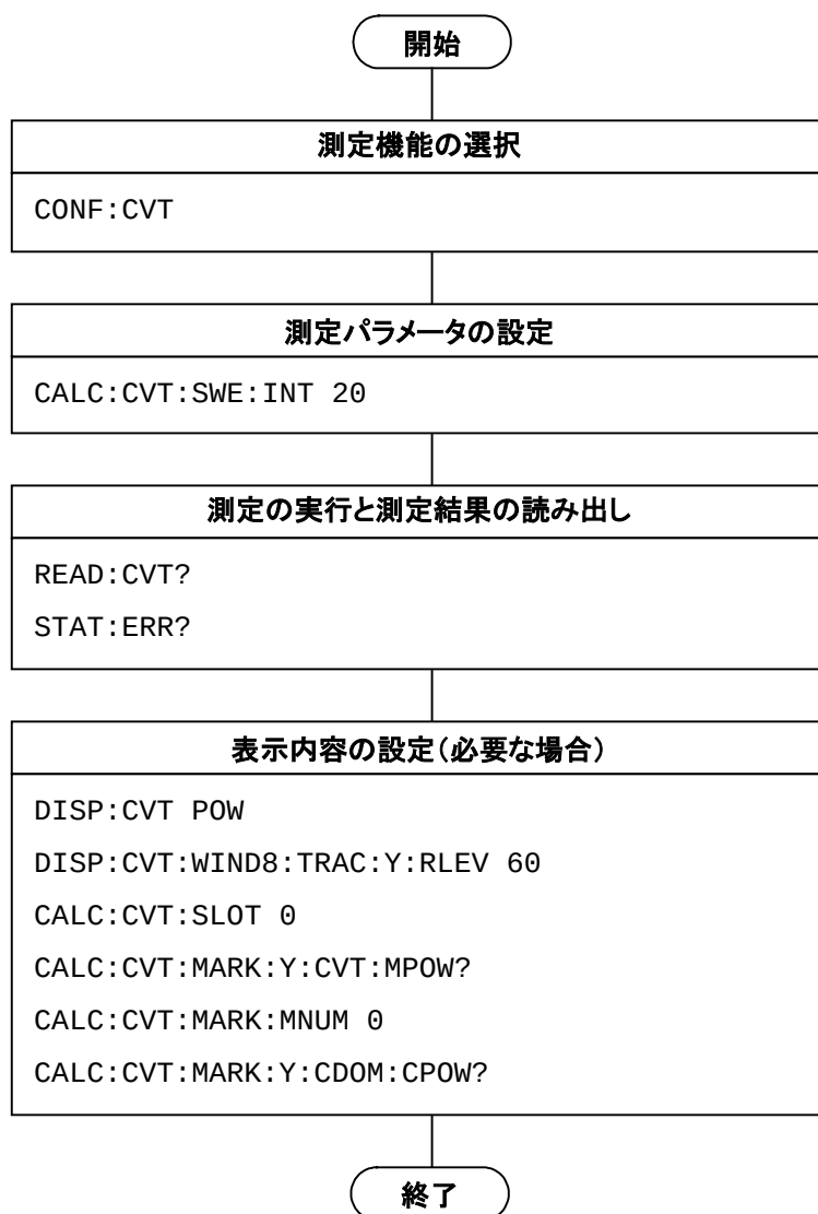
図1.2.6-1 Code vs Time 測定の流れとコマンド例
