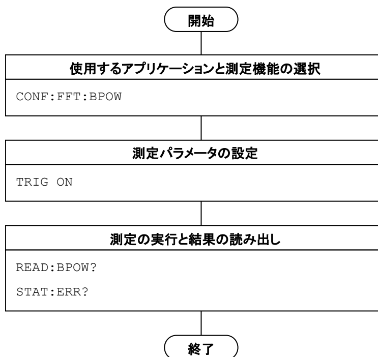
図 1.2.7-1 シグナルアナライザを使用した Burst Average Power 測定の流れとコマンド例
