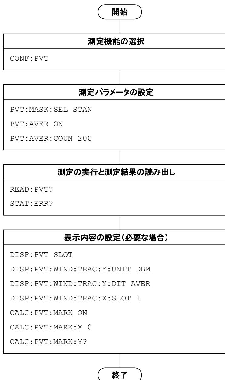
図 1.2.6-1 Power vs Time の流れとコマンド例
