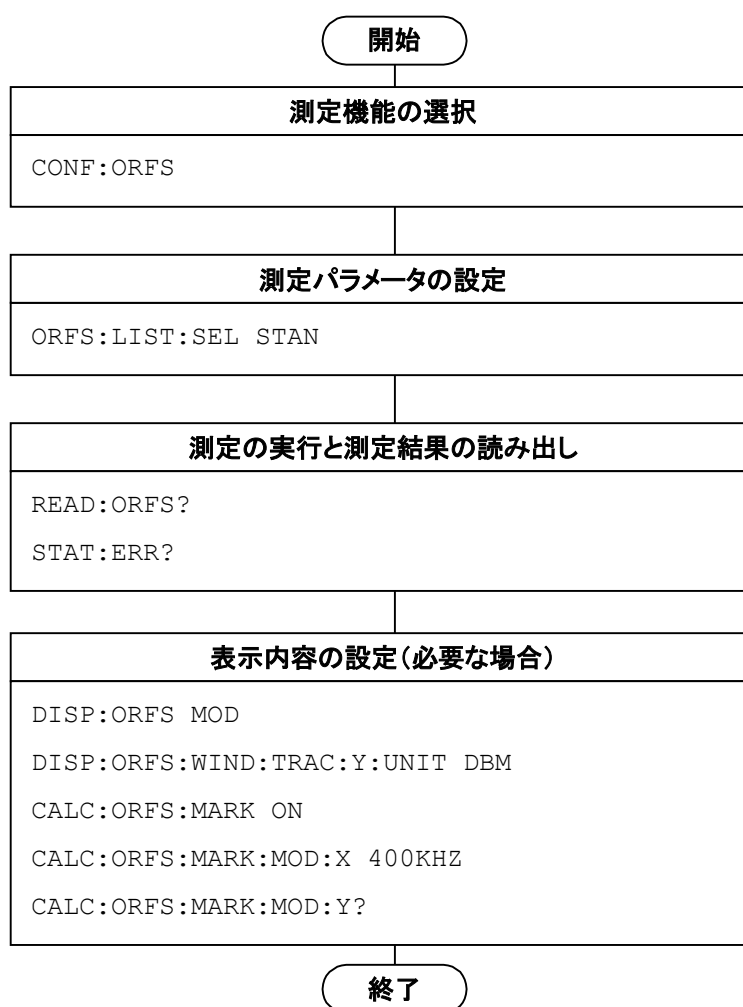
図 1.2.5-1 Output RF Spectrum の流れとコマンド例
