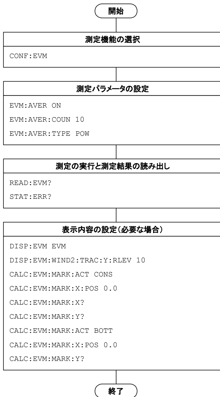
図 1.2.4-1 Modulation Analysis の流れとコマンド例
