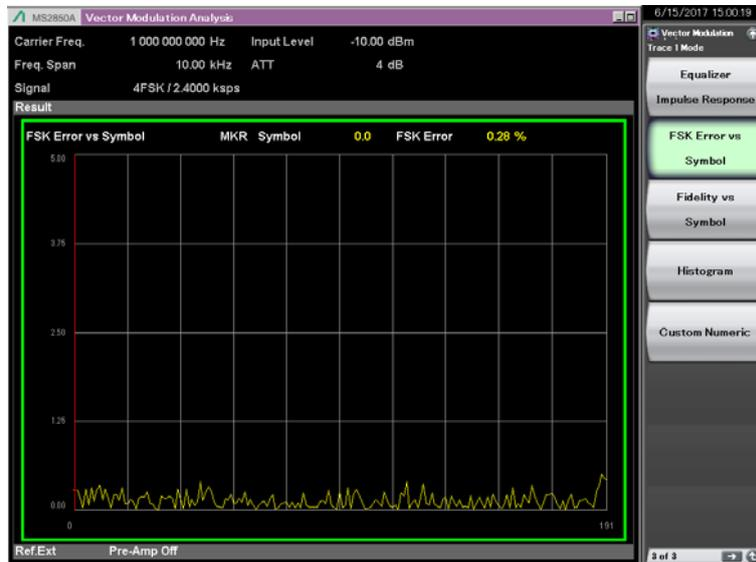
図3.8.1.18-1 FSK Error vs Symbol 結果
