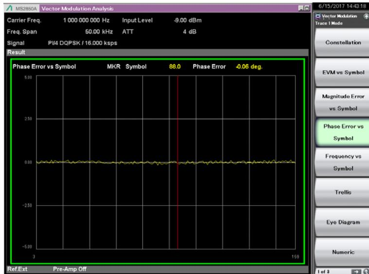
図3.8.1.4-1 Phase Error vs Symbol 結果
