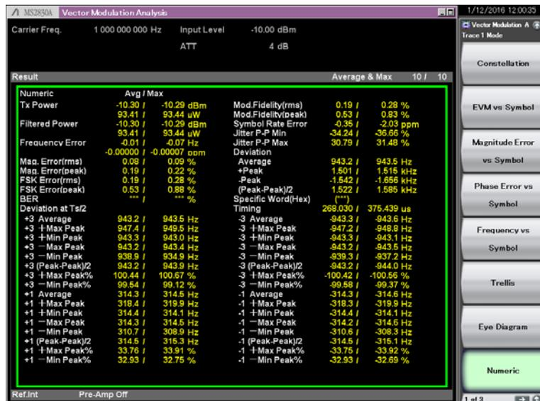
図3.8.1.8-2 Numeric 結果 (Modulation Type が 4FSK の場合)
