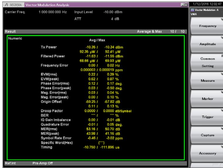
図3.8.1.8-1 Numeric 結果 (Modulation Type が PI/4DQPSK の場合)
