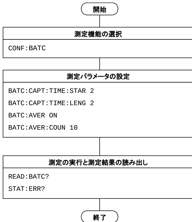
図 1.2.5-1 Batch 測定の流れとコマンド例
