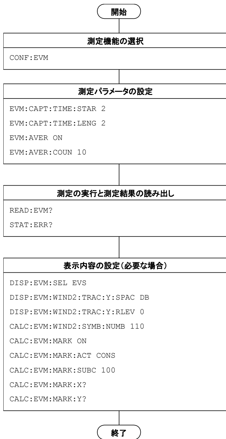
図 1.2.4-1 Modulation 測定の流れとコマンド例
