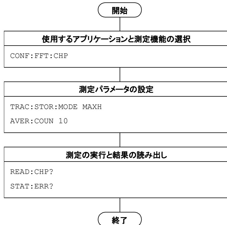
図 1.2.7-1 シグナルアナライザを使用した Channel Power 測定の流れとコマンド例
