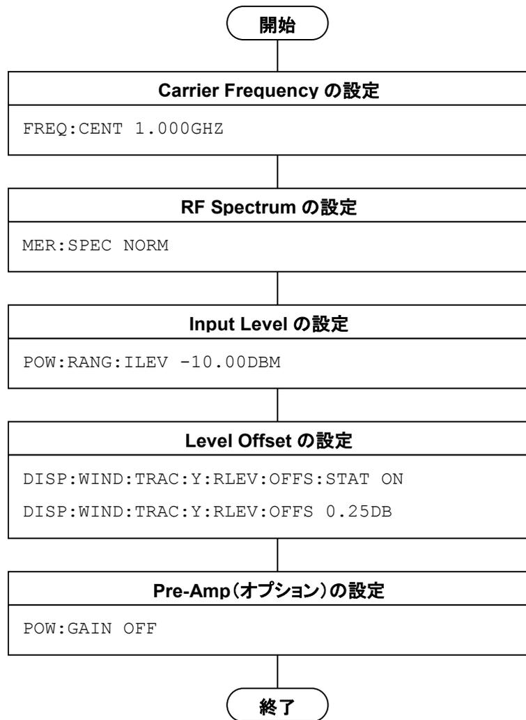
図 1.2.2-1 基本パラメータの設定の流れとコマンド例
