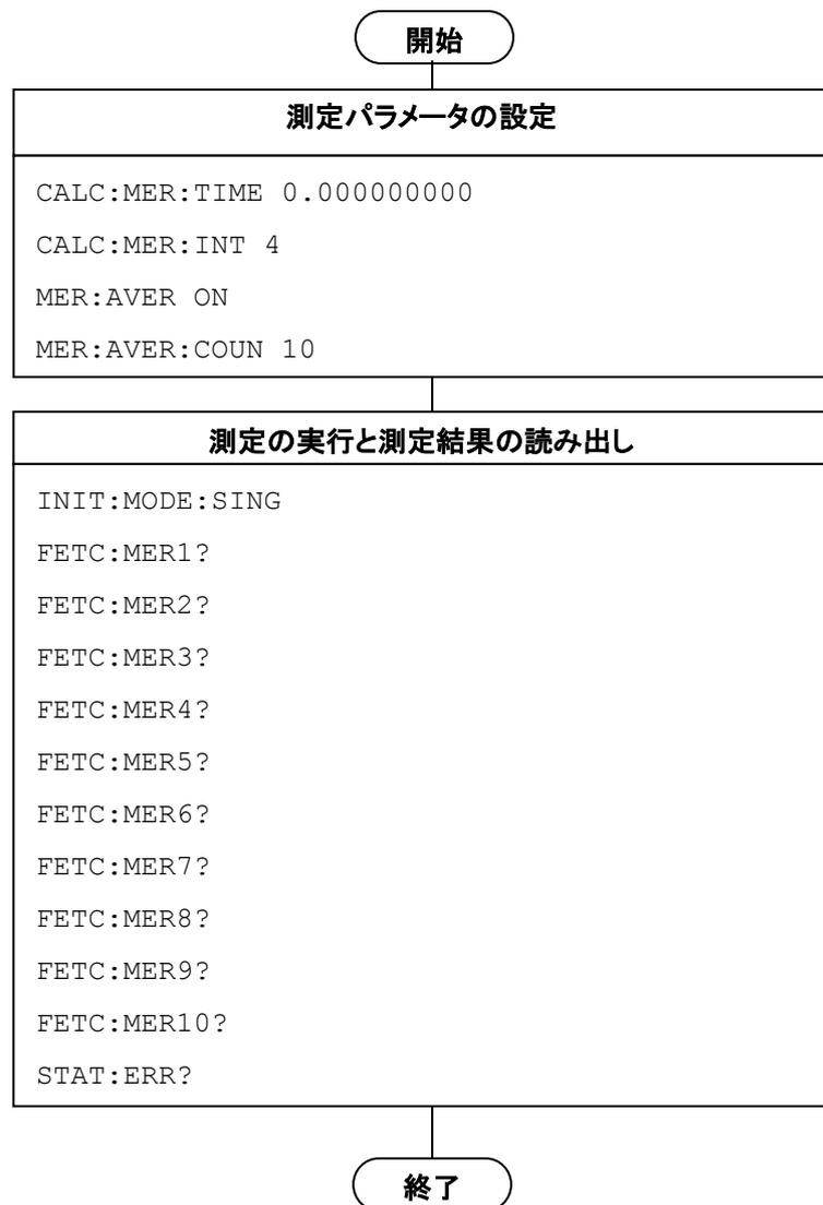
図 1.2.4-1 Modulation 測定の流れとコマンド例
