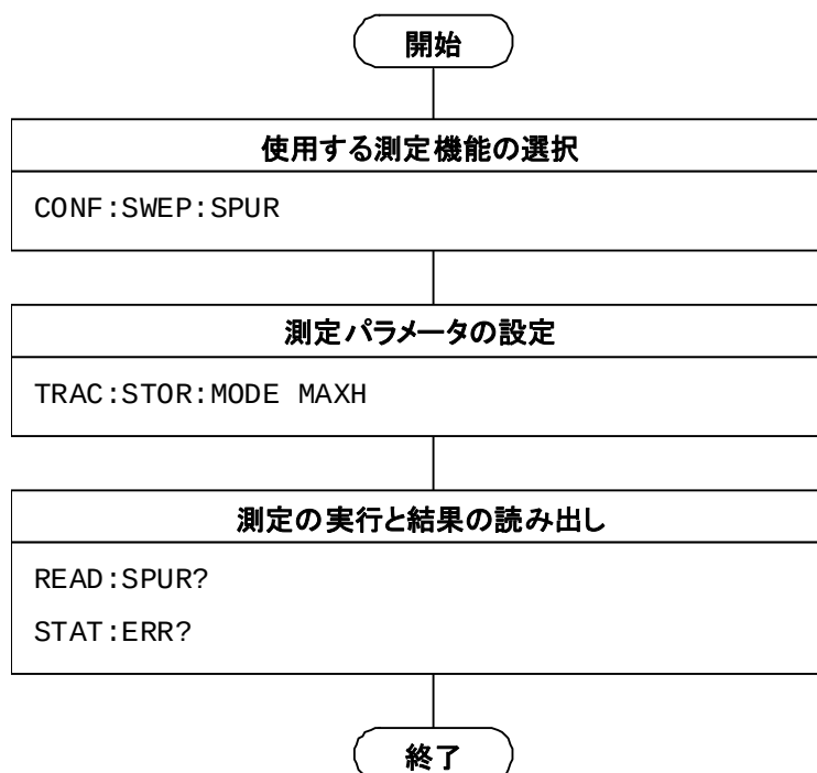
図 1.2.8-1 スペクトラムアナライザを使用した Spurious Emission 測定の流れとコマンド例
