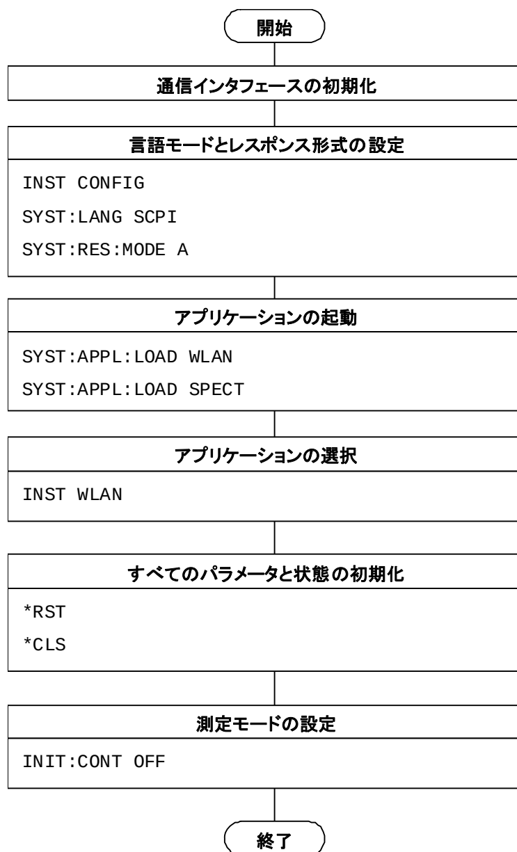
図1.2.1-1 初期設定の流れとコマンド例
