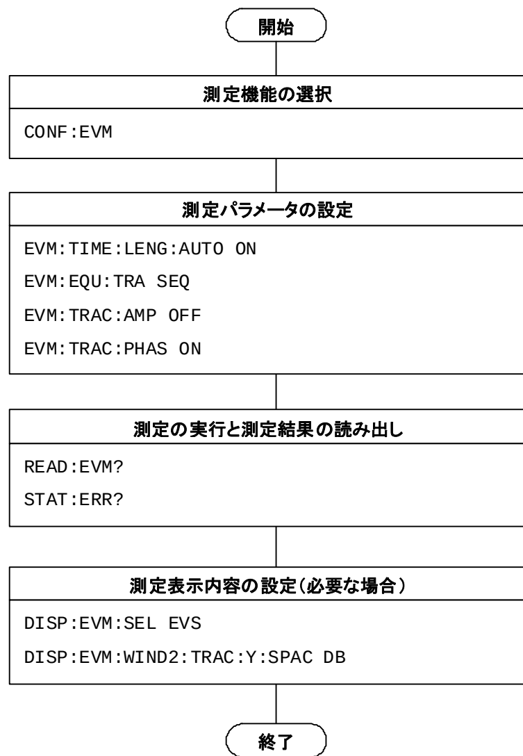
図1.2.4-1 Modulation 測定の流れとコマンド例
