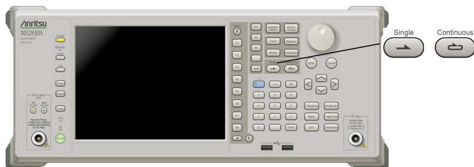
図2.2-1 Single キーおよび Continuous キー
