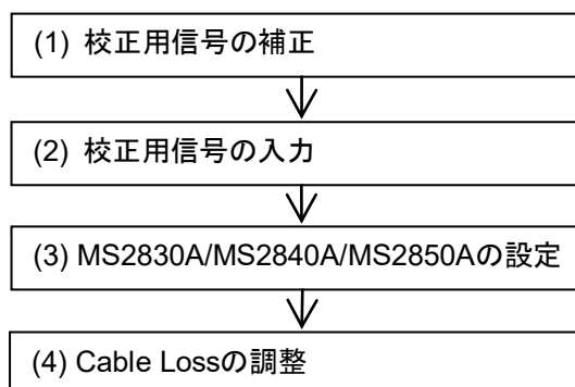
図8.10-1 外部ミキサのケーブルロスの設定手順
