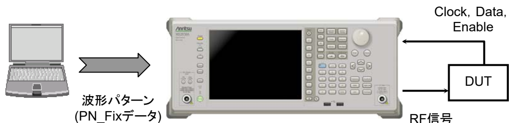
図8.8-6 PN_Fix データを使用した BER 測定
