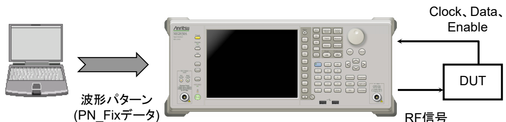
図8.8-6 PN_Fix データを使用した BER 測定
